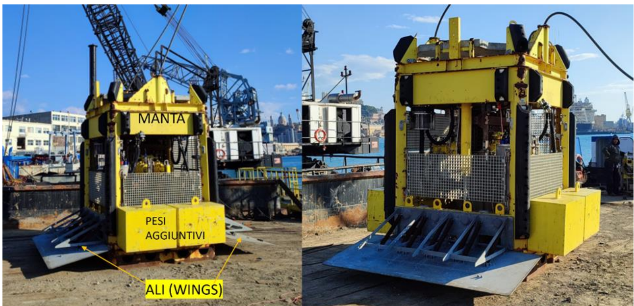
Figura 5-6: Dettagli del "seabed penetrometer" tipo "Manta" utilizzato per l'esecuzione delle prove CPT e DMT 2023
