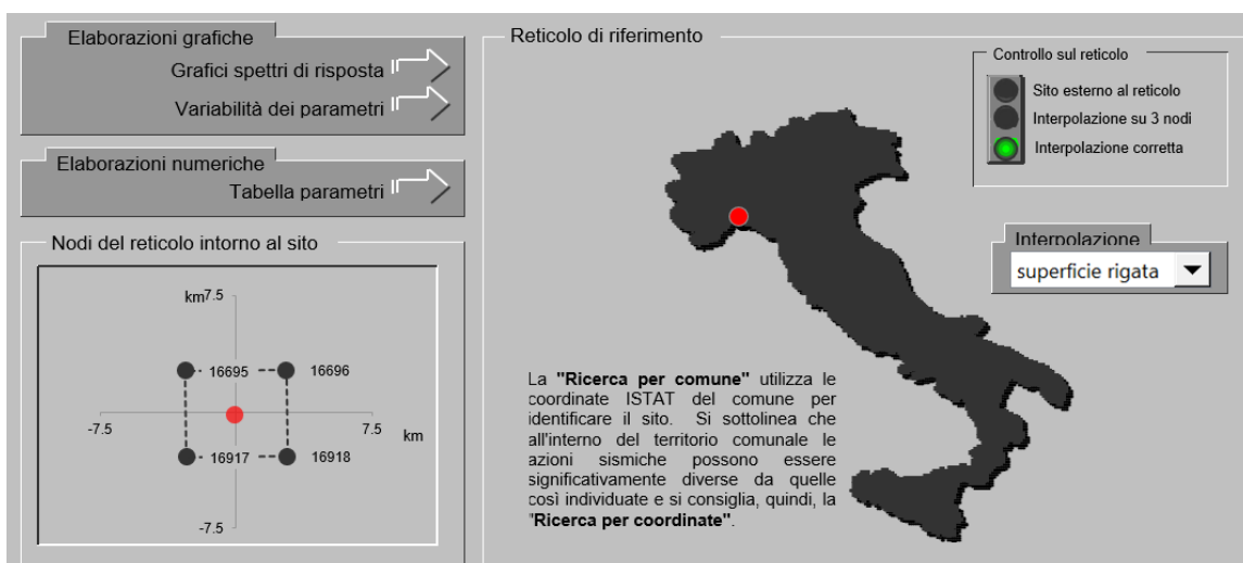
Figura 4-1: Nodi del reticolo di riferimento nell'intorno del sito di progetto Elaborazione da foglio di calcolo Spettri di Risposta SPETTRI-NTC v. 1.0.3b, distribuito dal Consiglio Superiore dei Lavori Pubblici, 2009
