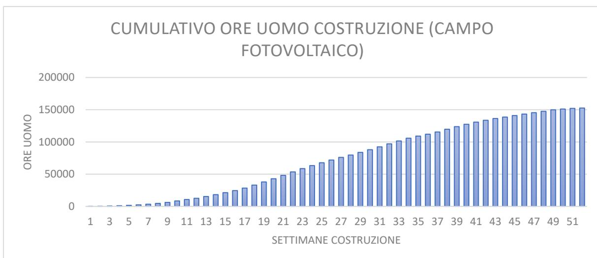
**Fig. 20 – Istogramma n° addetti costruzione / cumulativo ore uomo costruzione (campo agrivoltaico)**
