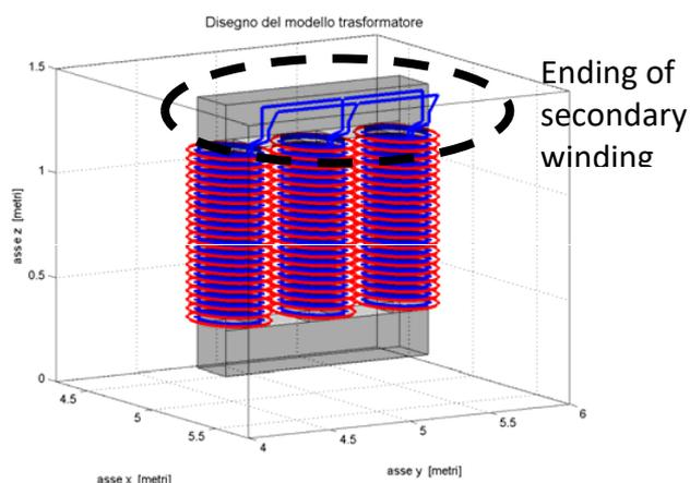
Fig. 14: Connessioni elettriche considerate al lati BT.
