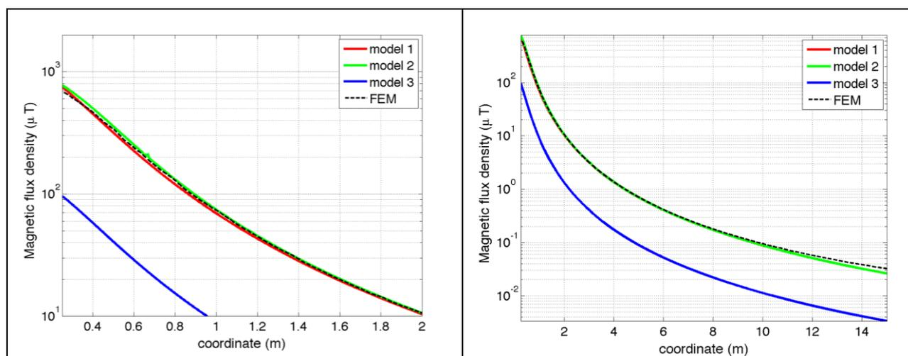
**Fig. 12. Induzione magnetica lungo la linea laterale**
