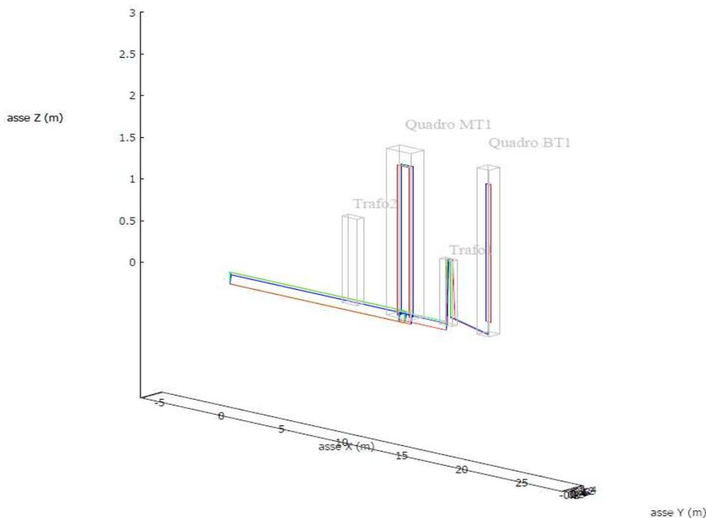
**Fig.7 - Modello spaziale cablaggi nelle cabine di ricezione**
