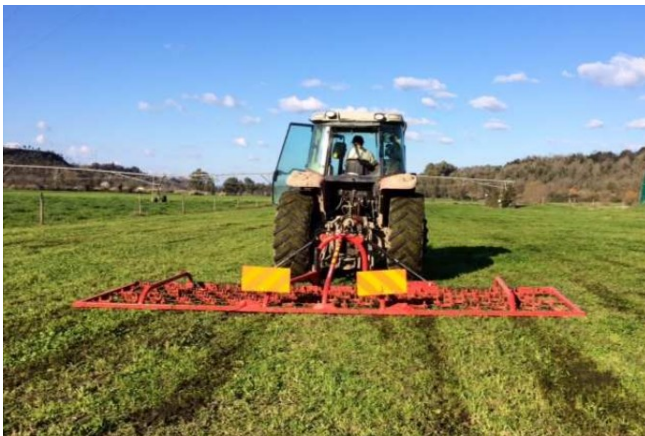
Figura 10-12 - Strigliatore con denti elastici
