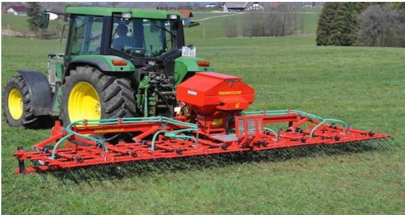
Figura 10-10 - Traseminatrice con denti strigliatori
