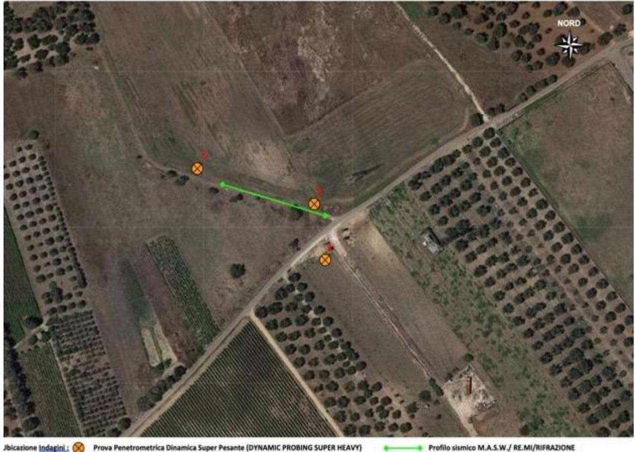
**Tavola n. 13: ubicazione prove penetrometriche e profilo sismico.**
