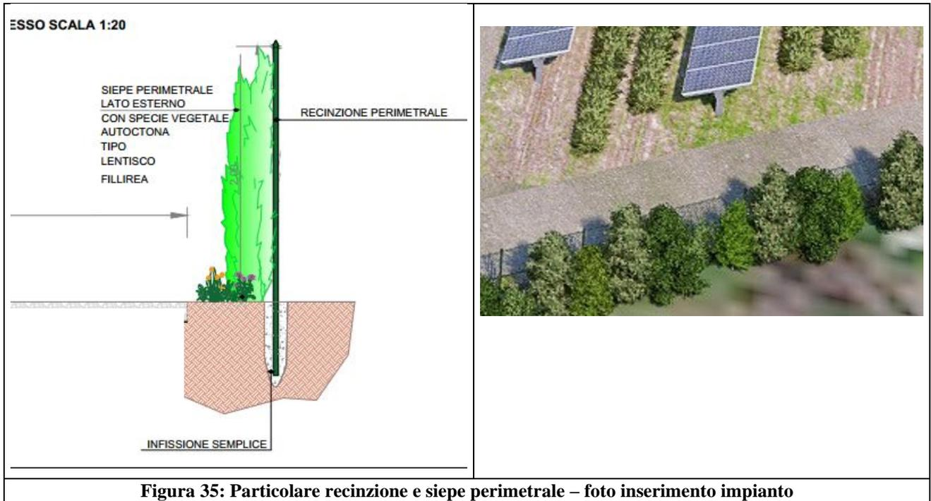
Figura 35: Particolare recinzione e siepe perimetrale – foto inserimento impianto
