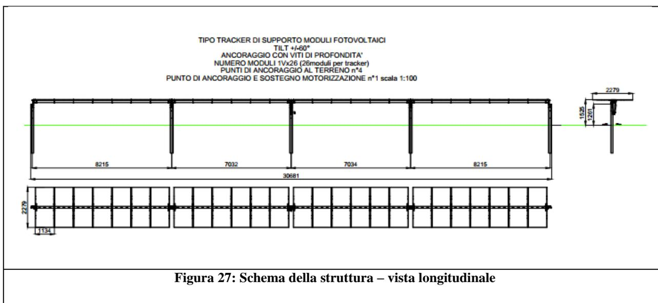
Figura 27: Schema della struttura – vista longitudinale
