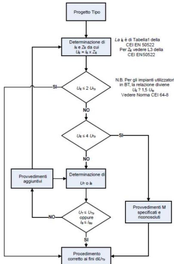
Con riferimento allo schema a blocchi illustrato sopra e tratto dalle norme CEI 99-3 ed indicando con  $U_{vTp}$  la tensione di contatto ammissibile a vuoto si ha che:
