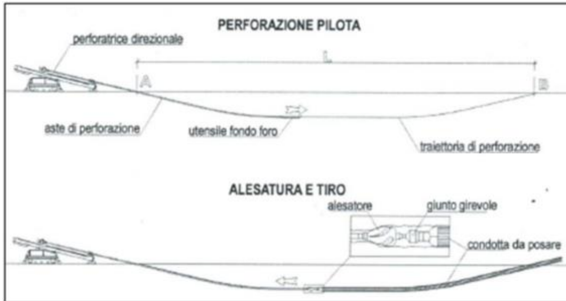
Tecnica della trivellazione orizzontale controllata
