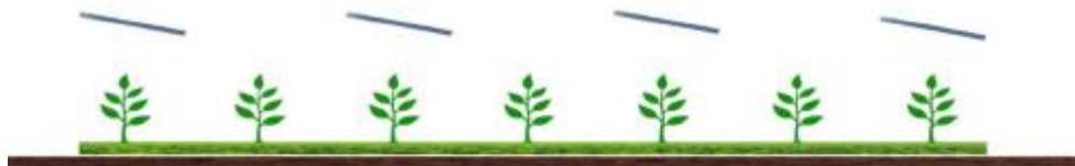
Figura 23: Sistema agrivoltaico in cui la coltivazione avviene tra le file dei moduli fotovoltaici, e sotto a essi (TIPO 1)
