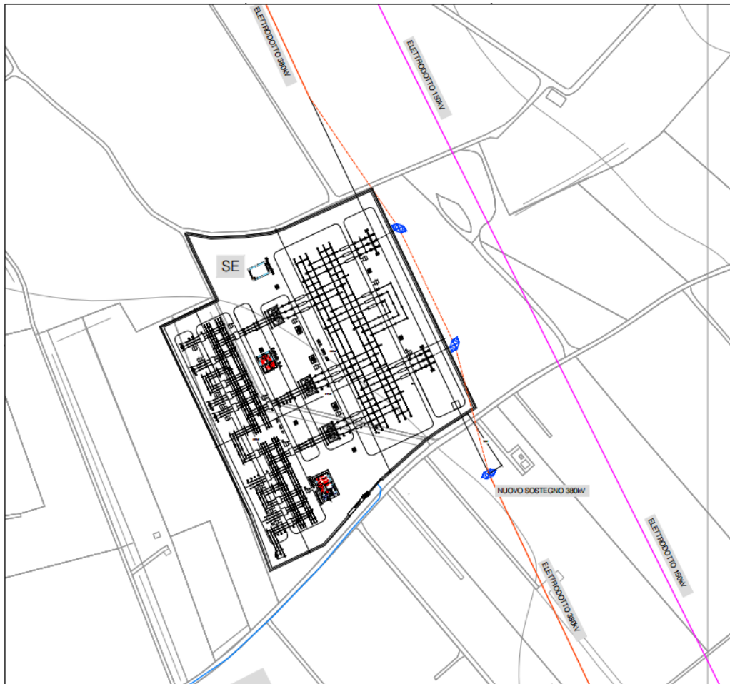
Figura 6: Layout della Stazione Elettrica
