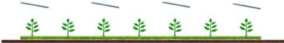
Figura 30: Sistema agrivoltaico in cui la coltivazione avviene tra le file dei moduli fotovoltaici, e sotto a essi (TIPO 1)
