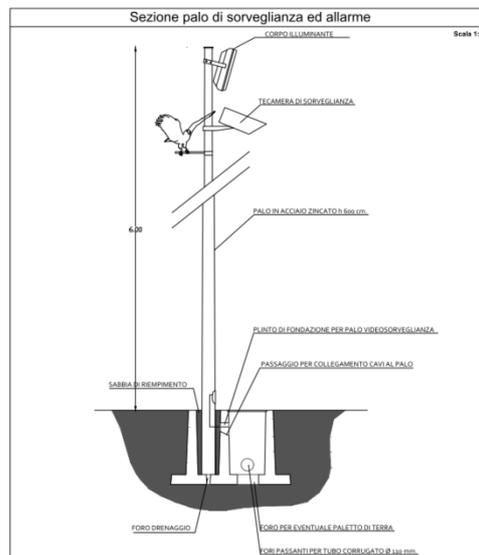
Saranno alloggiati in un pozzetto porta palo nel quale è previsto il passaggio dei cavi e l'alloggiamento del palo stesso.
