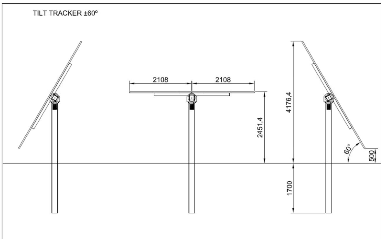
Figura 2 - Schema della struttura - sezione
