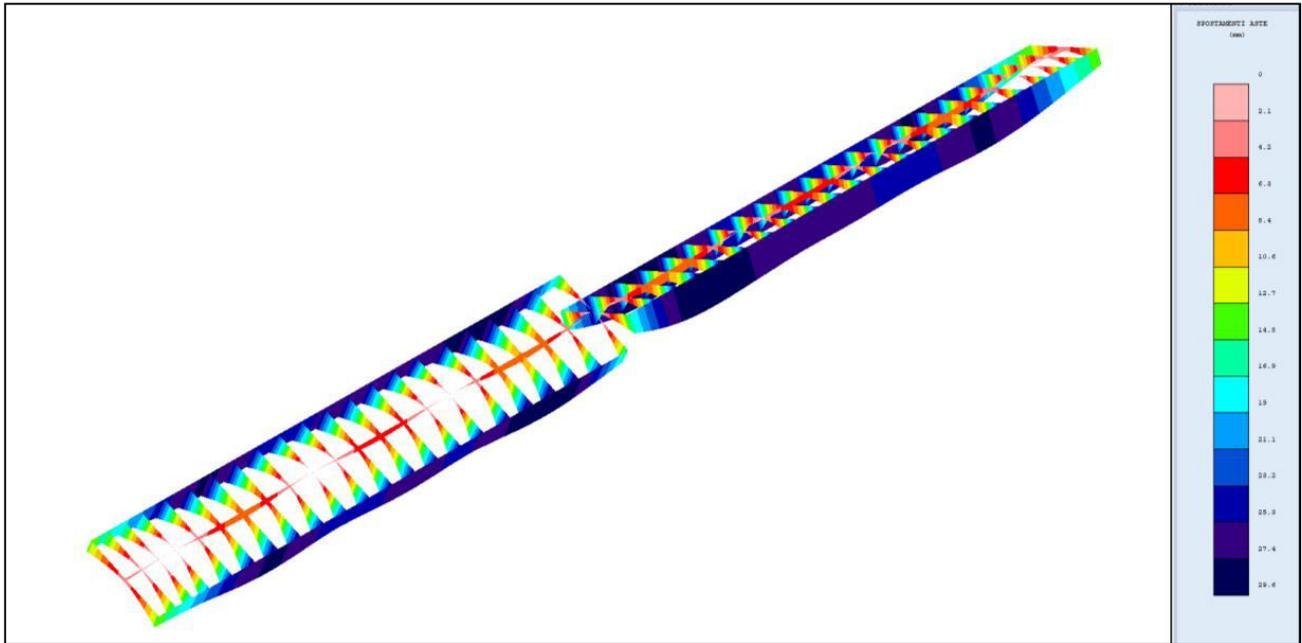
Figura 10 - DIAGRAMMA SPOSTAMENTI COMB.2 (VENTO)
