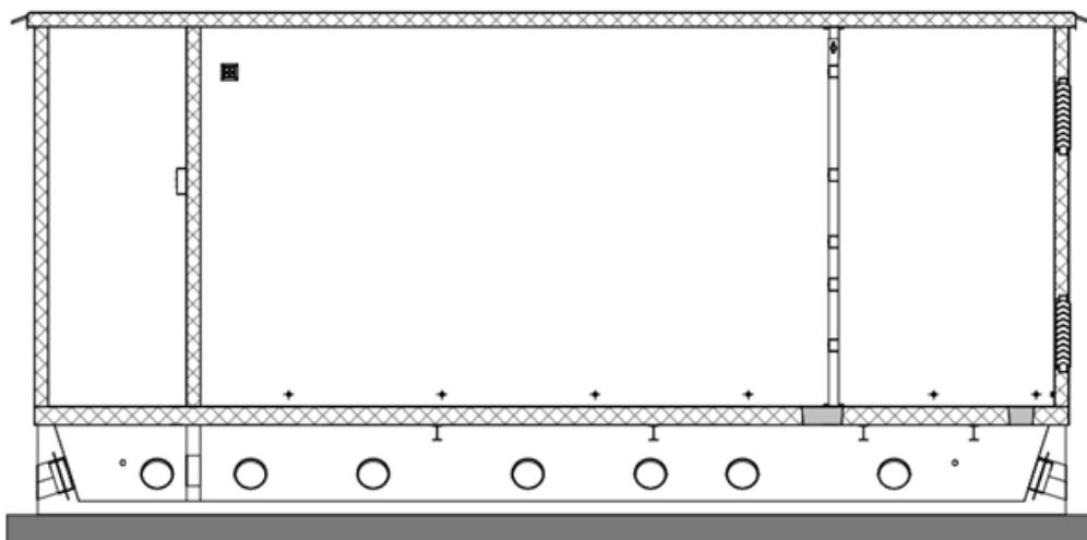
sezione del complessivo cabina + vasca di fondazione
