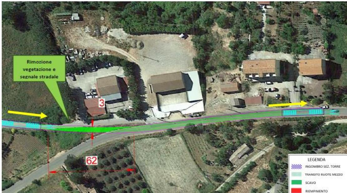
Figura 5-53 Interventi di rimozione della vegetazione - Focus 21.
