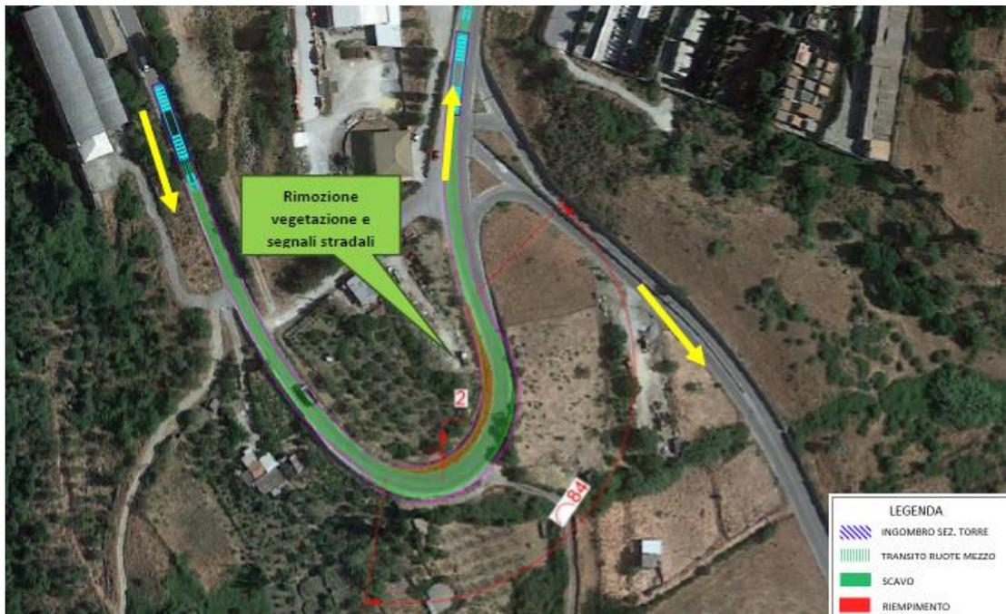
**Figura 5-40 Rimozione segnaletica nel tratto di SS120 – Focus 13.**
