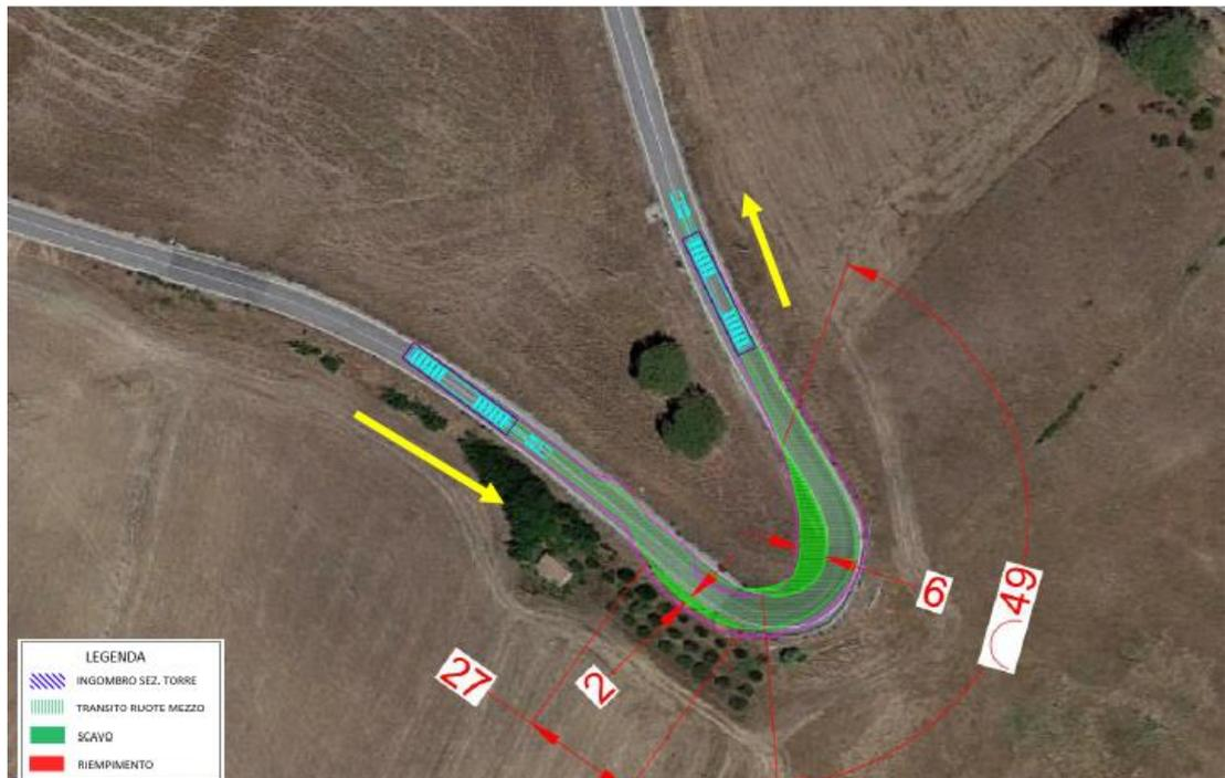
**Figura 5-35 Curva con raggio ridotto - Focus 9.**
