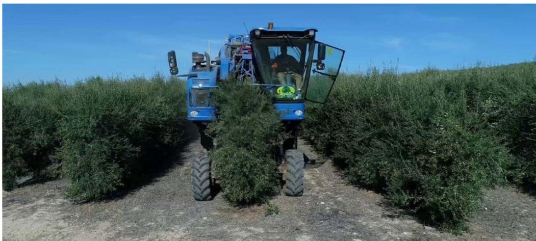
Con tale macchinario, che transita per sua concezione, a "cavallo" del filare di olivi e quindi perfettamente al centro dello spazio lasciato libero dalle strutture orientabili che portano i pannelli, non si pone alcun rischio di interferenza con tali strutture, in quanto lo spazio libero è di tutta sicurezza, anche nei momenti in cui le strutture di ritrovassero orizzontali (verso l'orario di mezzogiorno durante la giornata)
