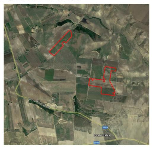
L'impianto fotovoltaico in progetto prevede l'installazione a terra, su un unico lotto di terreno di estensione complessiva di circa 316.000 m² attualmente a destinazione agricola condotti a seminativo, di pannelli fotovoltaici (moduli) in silicio monocristallino della potenza unitaria di 665 Wp.
