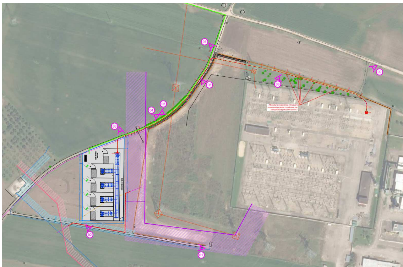
Planimetria generale nuova cabina AT/MT e collegamento in cavo AT – Planimetria di progetto su rilievo
