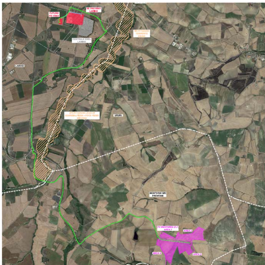
Fig. 10 11 – Andamento cavidotto MT su ortofoto
