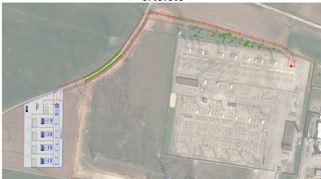
Fig. 13-14 – Planimetria generale nuova cabina AT/MT e collegamento in cavo AT – Planimetria di progetto su ortofoto
