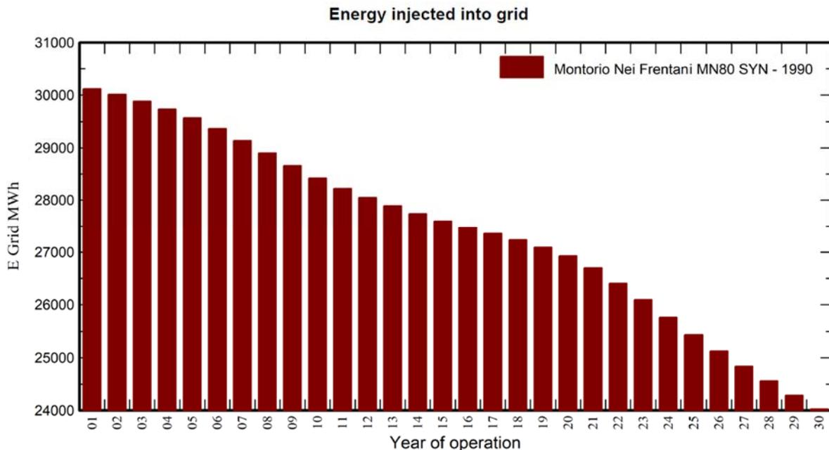
**Fig. 26 – Producibilità dell’impianto con degrado moduli (30 anni)**
