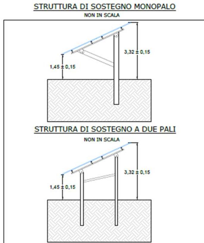
**Fig. 5 - Struttura di supporto moduli**
