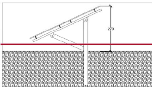
STRUTTURA DI SOSTEGNO A DUE PALI
