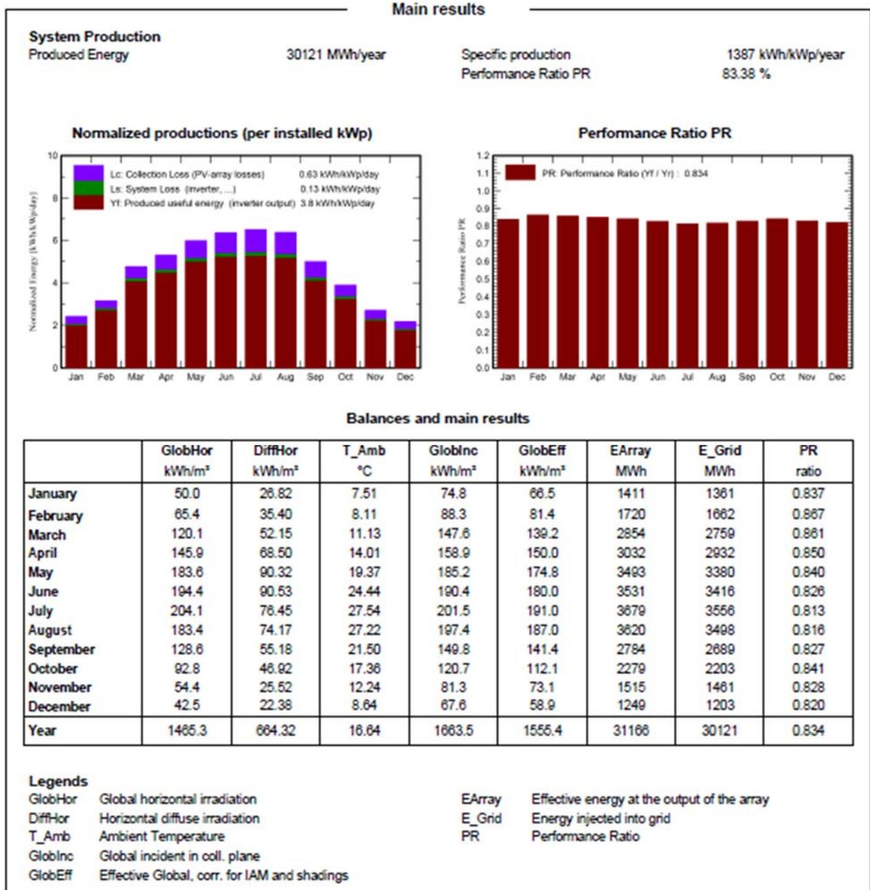
**Fig. 25 - Risultati di calcolo (Fonte: PVsyst - Meteonorm)**
