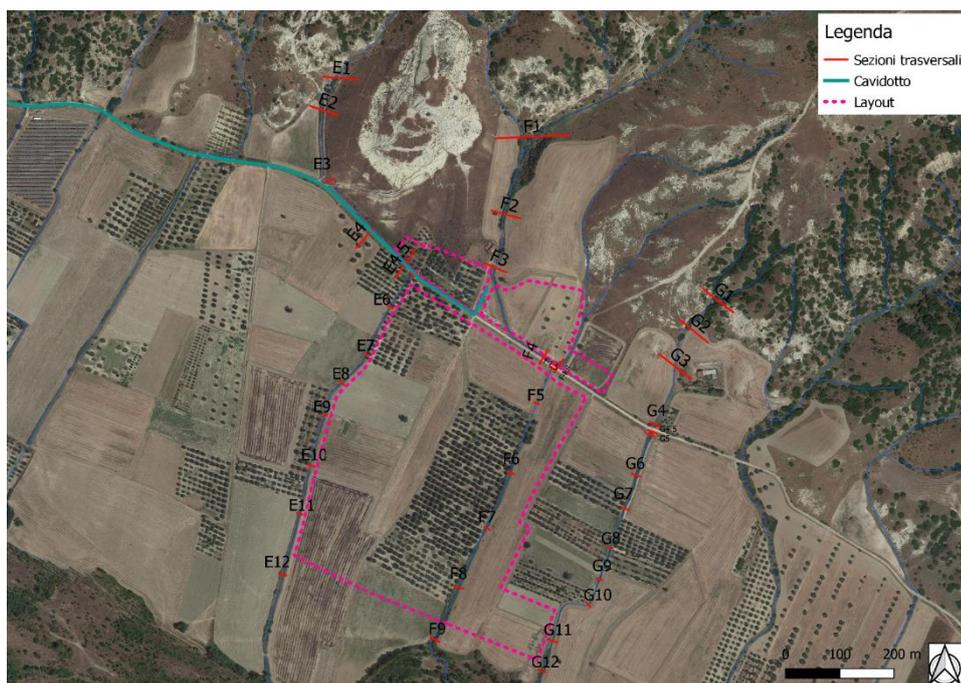
Figura 37: Planimetria dei canali analizzati con l'individuazione delle sezioni trasversali rilevate
