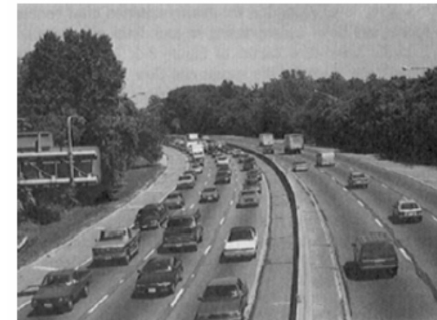
Figura 5.25 Condizioni di circolazione LOS F
