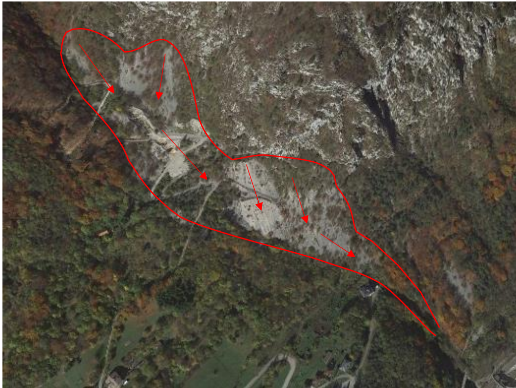
Fig. 19 - Dissesto a monte dello sbocco nord della galleria
