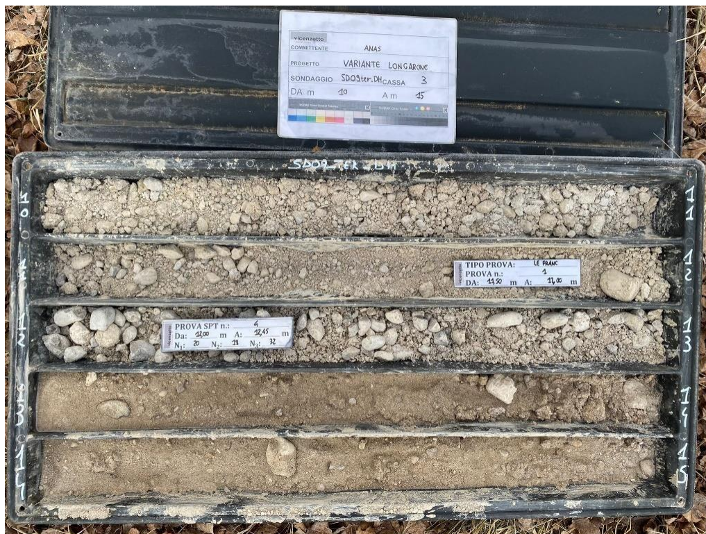
Fig. 108 – Sondaggio SD09ter_DH, cassetta del carotaggio da 10 a 15 m da pc. con ghiaie e sabbie
