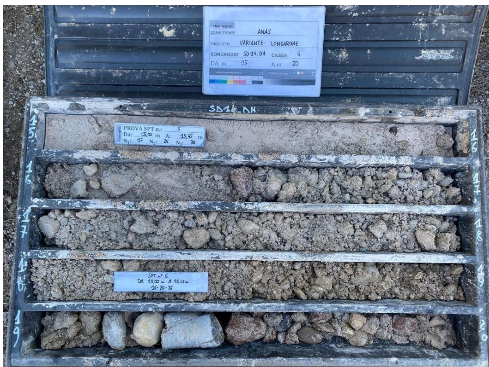
Fig. 116 – Sondaggio SD14_DH, cassetta del carotaggio da 15 a 20 m da pc. con ghiaia, sabbia e limo
