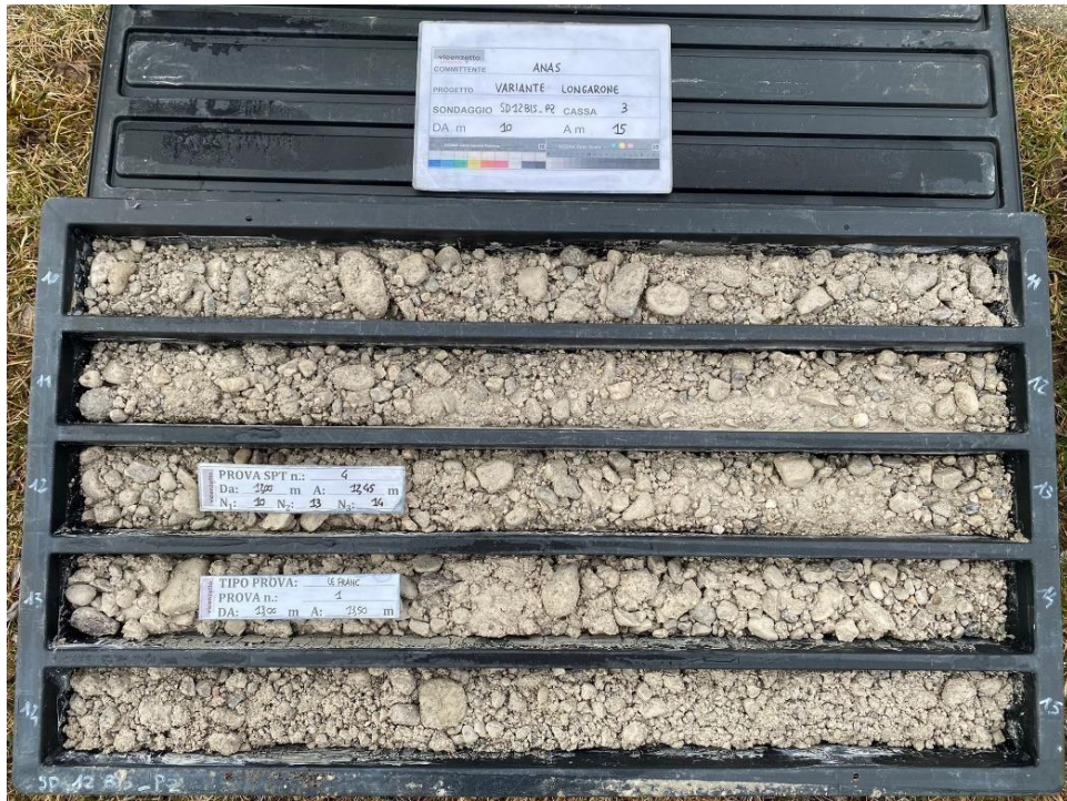
Fig. 114 – Sondaggio SD12bis_PZ, cassetta da 10 a 15 m da pc. con ghiaie e ghiaie sabbiose
