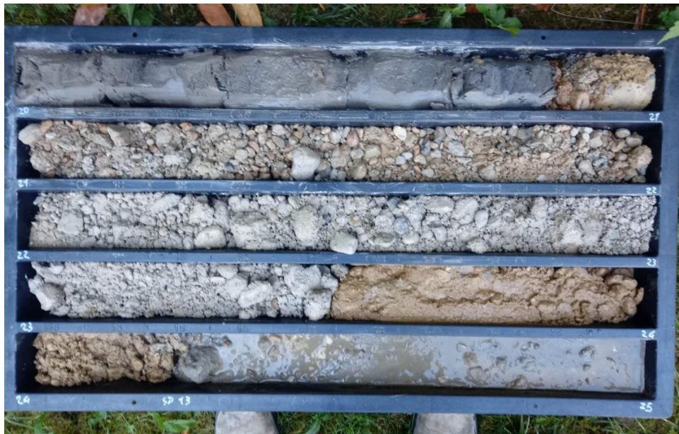
Fig. 115 – Sondaggio SD13_DH, cassetta del carotaggio da 20 a 55 m da pc. con ghiaia, sabbia e limo
