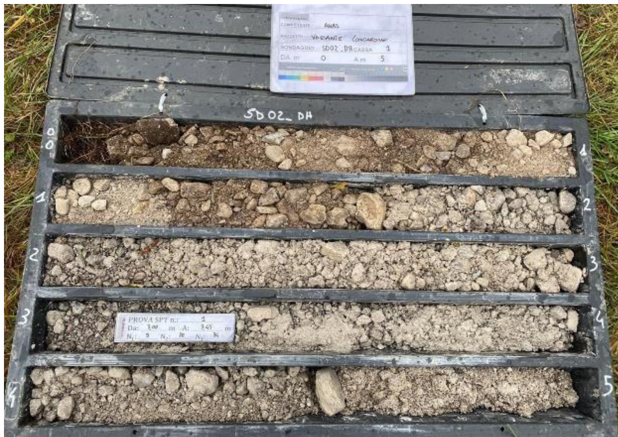
Fig. 99 – Cassetta del carotaggio da 1 a 5 m da pc., sondaggio SD02_DH granulometria grossolana
