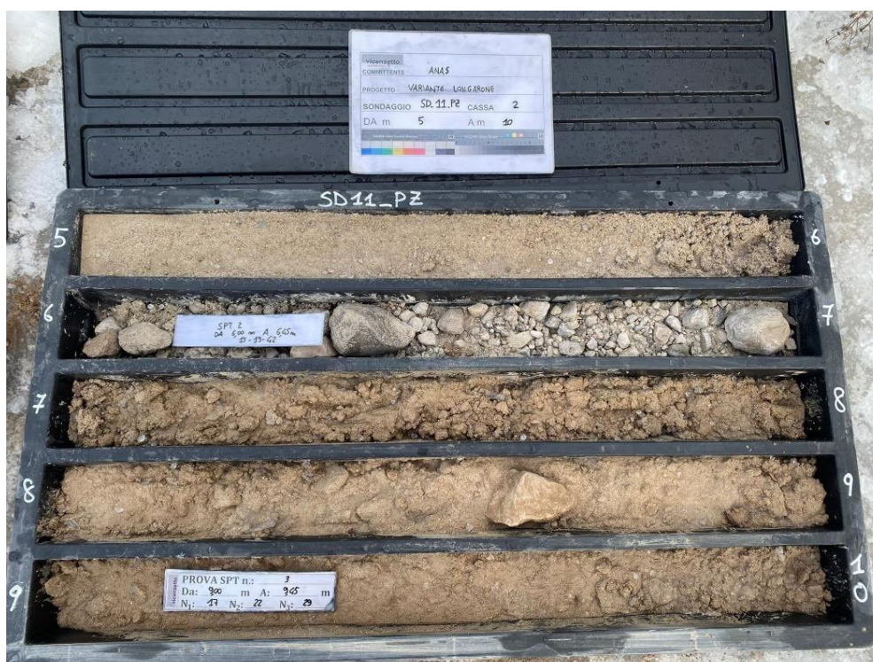
Fig. 112 – Sondaggio SD11_PZ, cassetta del carotaggio da 5 a 10 m da pc. con sabbie, sabbie ghiaiose, ghiaie e sabbie limose
