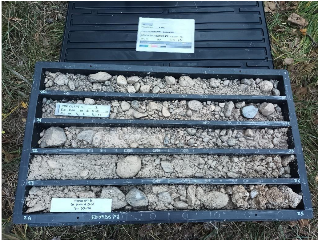
Fig. 110 – Sondaggio SD09bis_PZ, cassetta del carotaggio da 20 a 25 m da pc. con ghiaie e ciottoli
