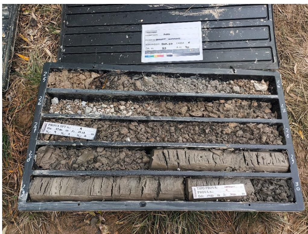
Fig. 99 – Cassetta del carotaggio da 1 a 5 m da pc., sondaggio SD02_DH granulometria grossolana
