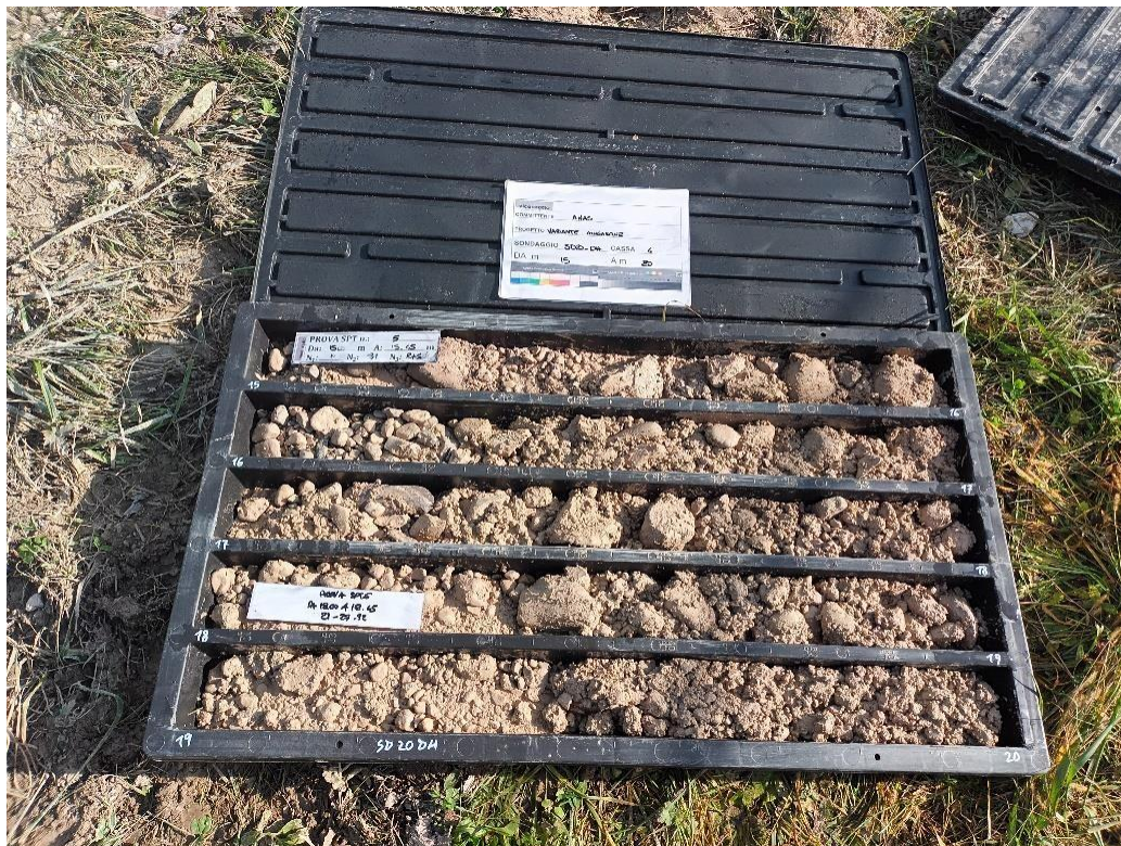
Fig. 121 – SD20_DH cassetta da 15 a 20 m da pc. in corrispondenza della Spalla S del Viadotto Malcolm
