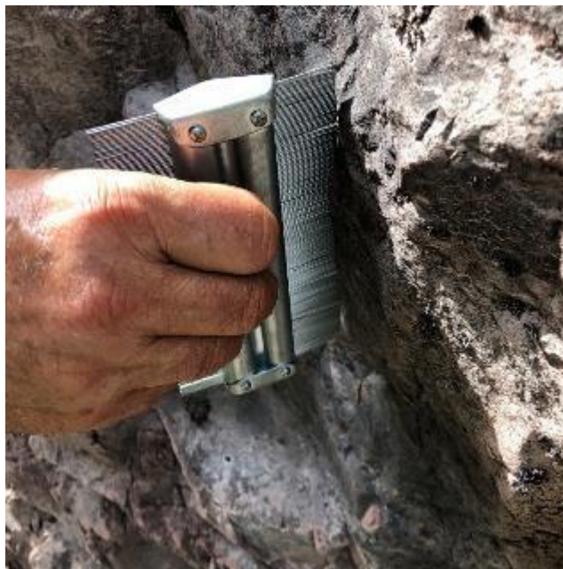
Fig. 74 – Rilievo con Profilometro
