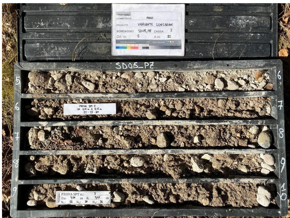
Fig. 107 – Sondaggio SD09_PZ, cas5etta del carotaggio da 5 a 10 m da pc. con ghiaie
