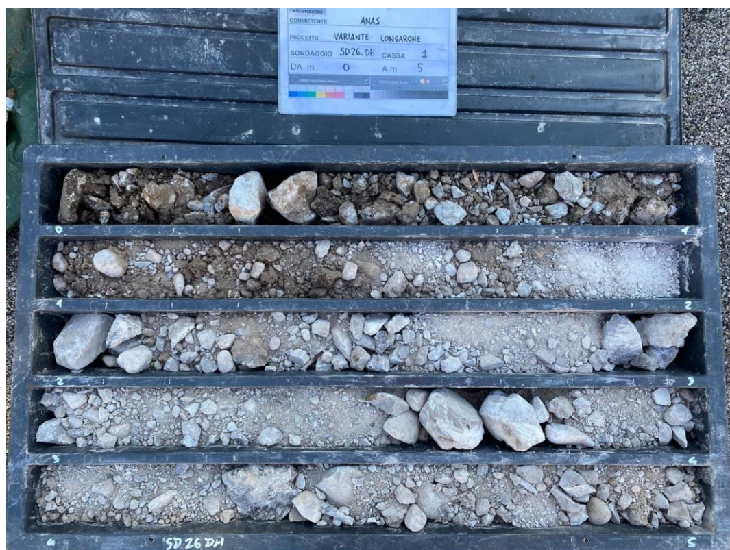
Fig. 127 – Cassetta del carotaggio da 0 a 5 m da pc. del sondaggio SD26
