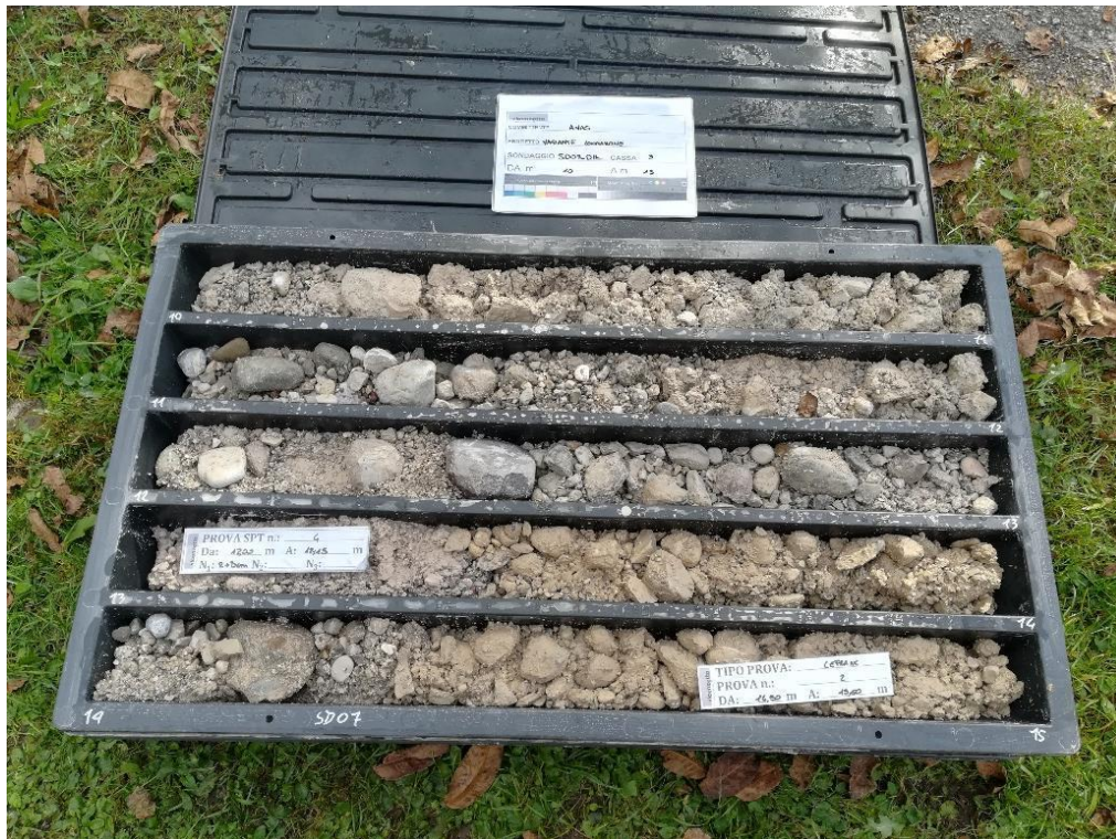
Fig. 105 – Sondaggio SD07_DH, cassetta del carotaggio da 10 a 15 m da pc. con ghiaie prevalenti
