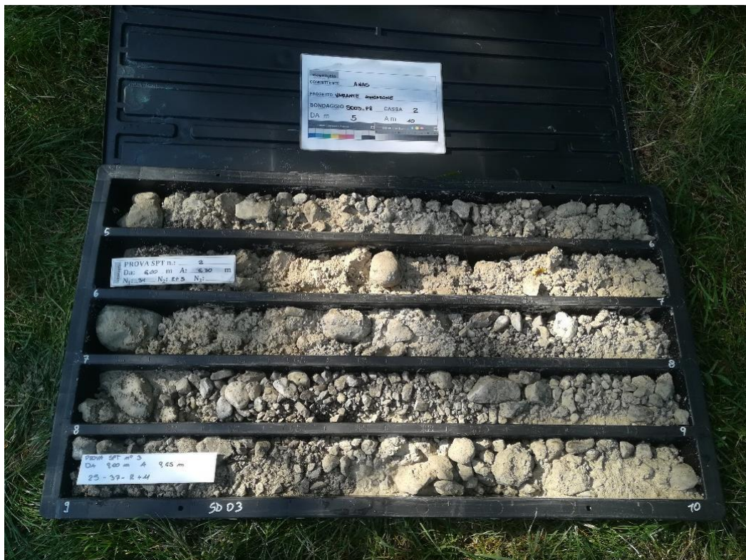
Fig. 102 – Sondaggio SD03_PZ, cassetta del carotaggio da 5 a 10 m da pc. con ghiaie prevalenti
