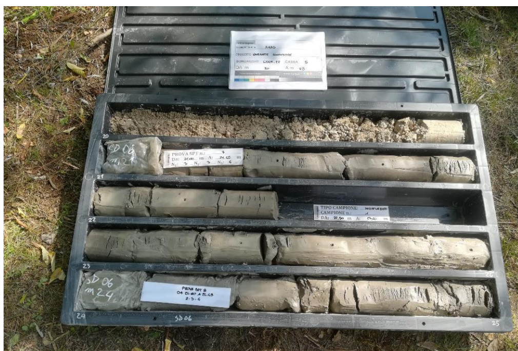
Fig. 104 – Sondaggio SD06_PZ, cassetta del carotaggio da 20 a 25 m da pc., lente di argilla limosa
