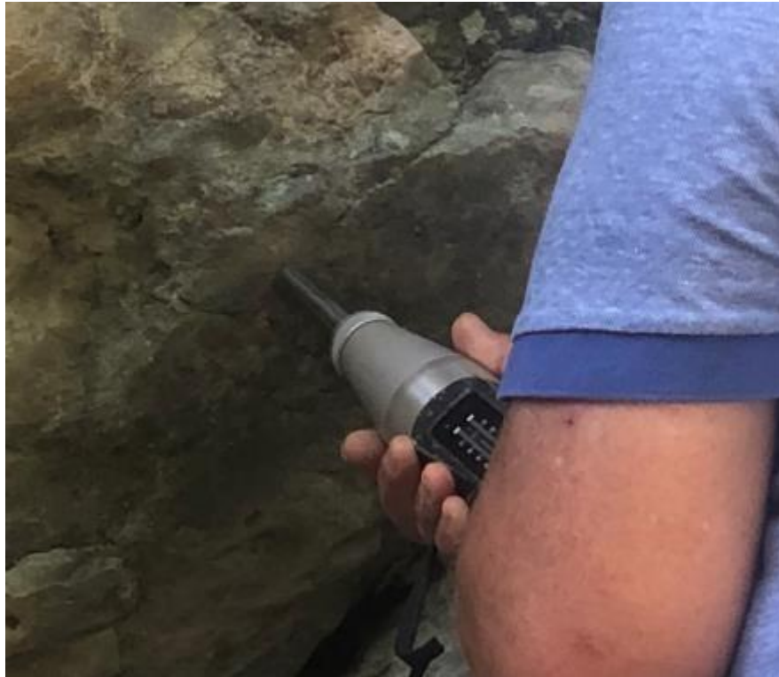
Fig. 75 – Misura di resistenza della roccia con martello di Schmidt.
