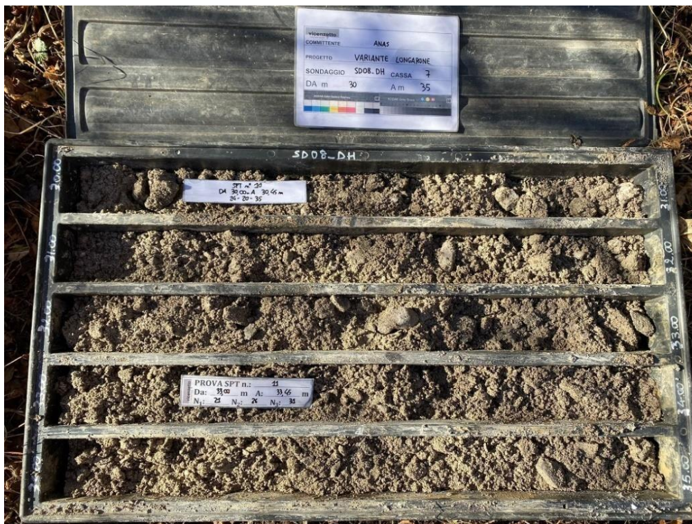
Fig. 106 – Sondaggio SD08_DH, cassetta del carotaggio da 30 a 35 m da pc. con sabbie prevalenti
