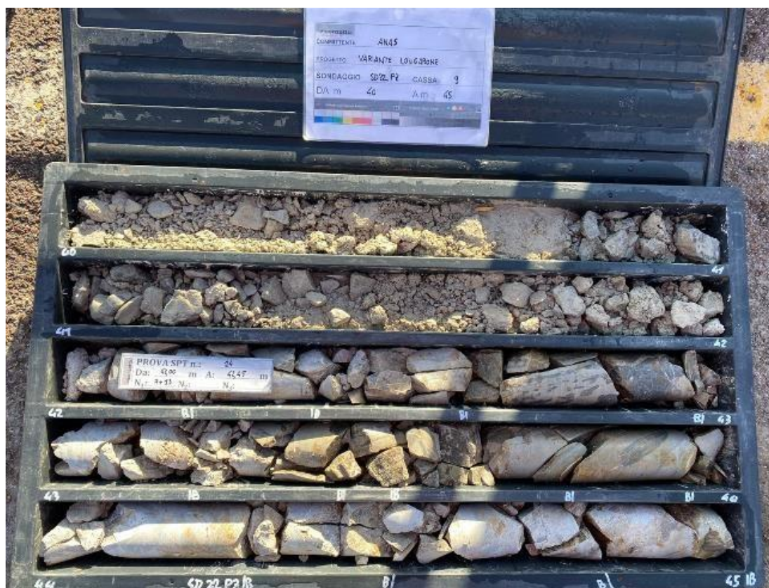
Fig. 123 – Cassetta del carotaggio da 40 a 45 m da pc. del sondaggio SD22_PZ in prossimità dell'imbocco S della Galleria Castellavazzo
