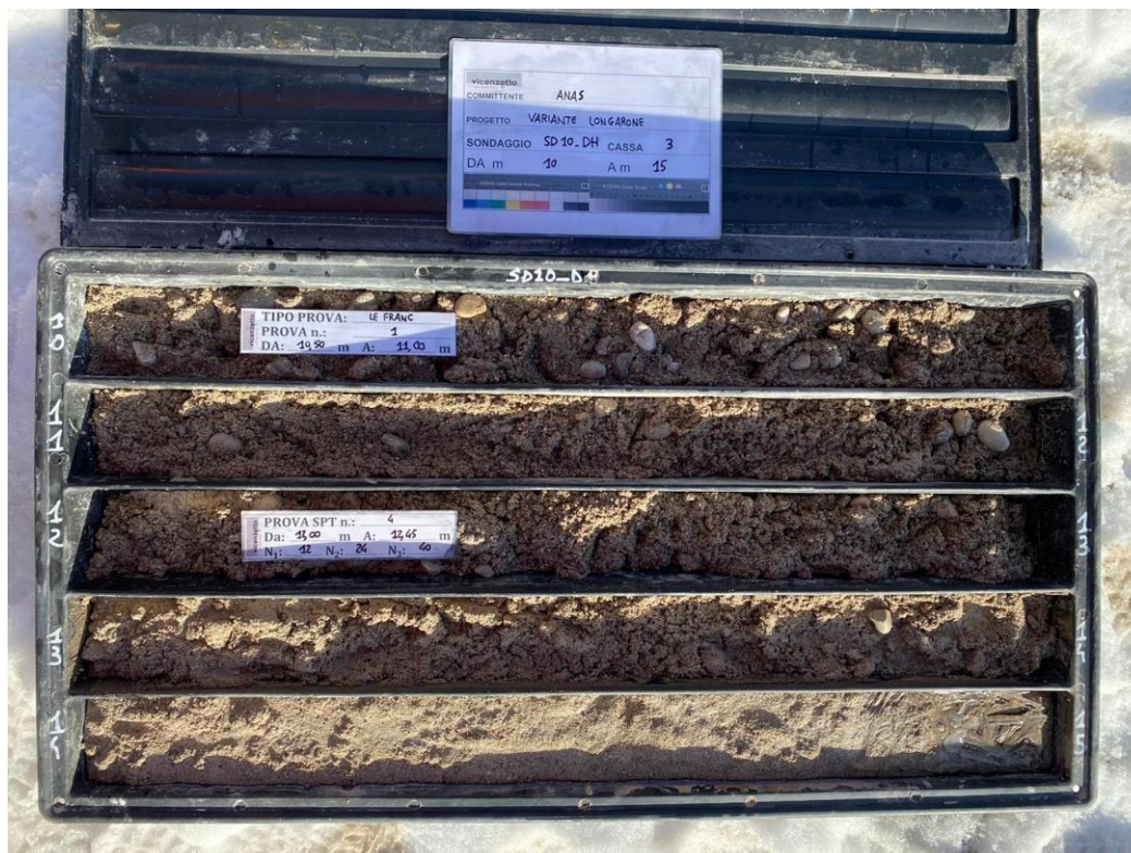
Fig. 111 – Sondaggio SD10_DH, cassetta del carotaggio da 10 a 15 m da pc. con sabbie ghiaiose ghiaie e limose
