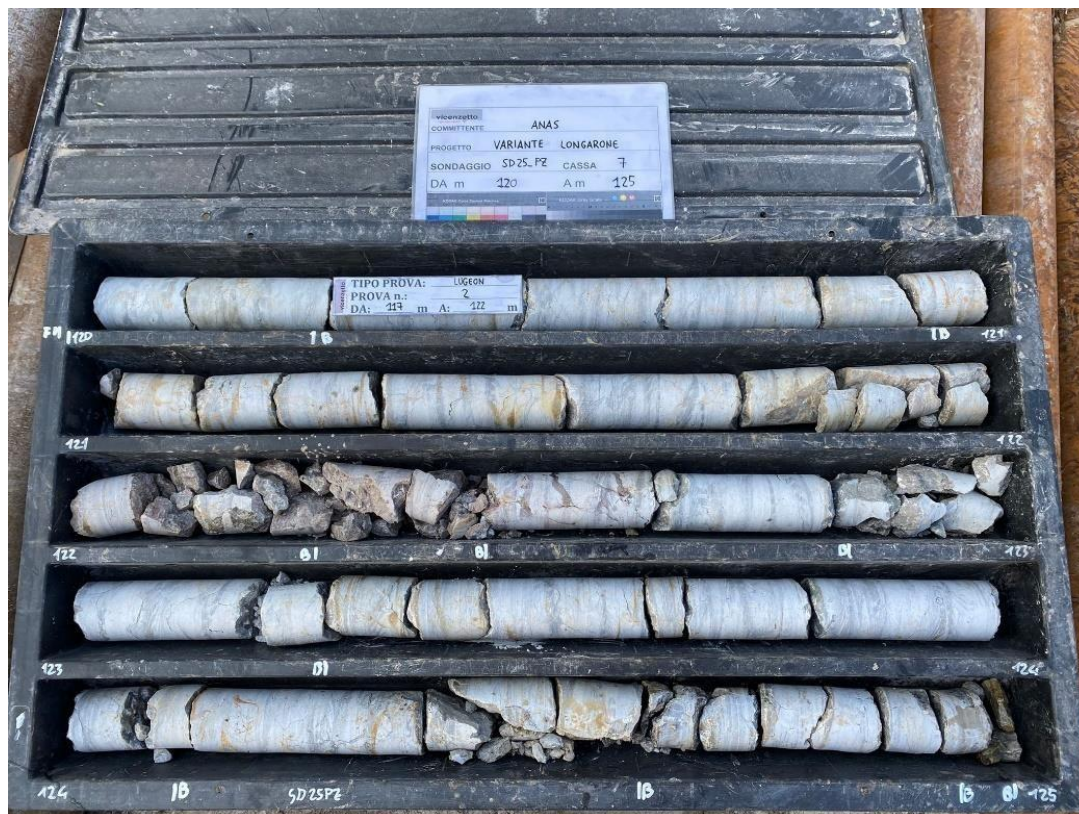
Fig. 126 – Cassetta del carotaggio da 120 a 125 m da pc. del sondaggio SD25_PZ
