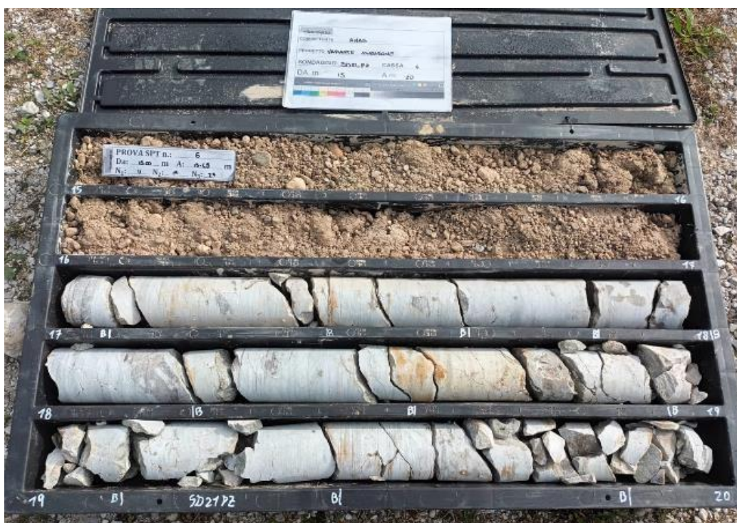
Fig. 122 – SD21_DH cassetta da 15 a 20 m da pc in corrispondenza della Spalla N del Viadotto Malcolm
