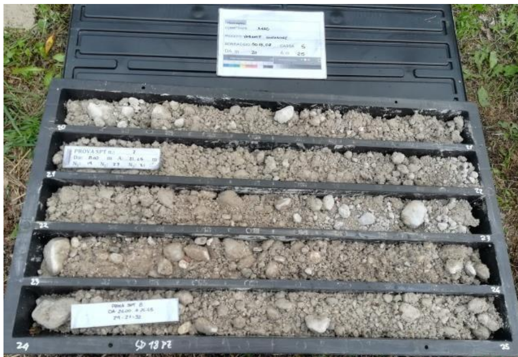
Fig. 119 – SD18_PZ in corrispondenza della Pila P6 del Viadotto Fiera Cassetta da 20 a 25 m da pc.
