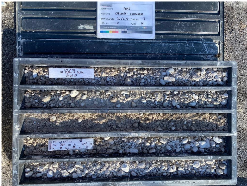
Fig. 113 – Sondaggio SD12_PZ, cassetta del carotaggio da 30 a 35 m da p.c. con ghiaie e ghiaie sabbiose
