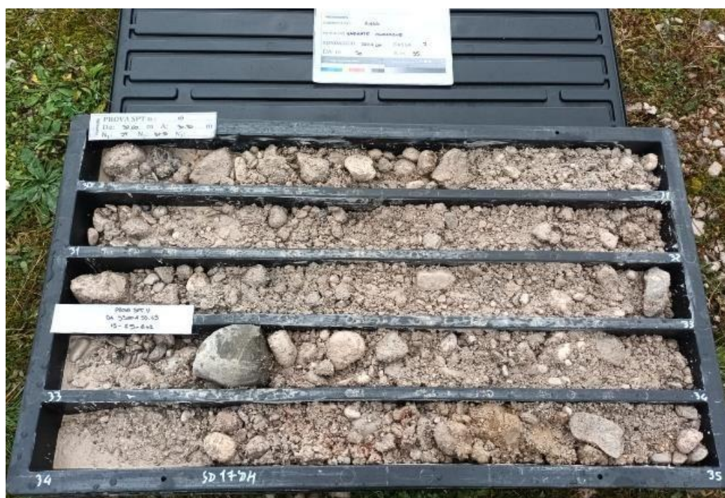
Fig. 118 – SD17_DH in corrispondenza della spalla S del Viadotto Fiera, cassetta del carotaggio da 30 a 35 m da pc.
