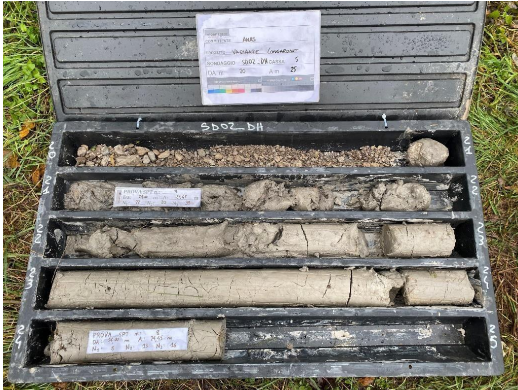
Fig. 101 – Sondaggio SD02_DH, cassetta del carotaggio da 25 a 30 m da pc., con livello argilloso-limoso
