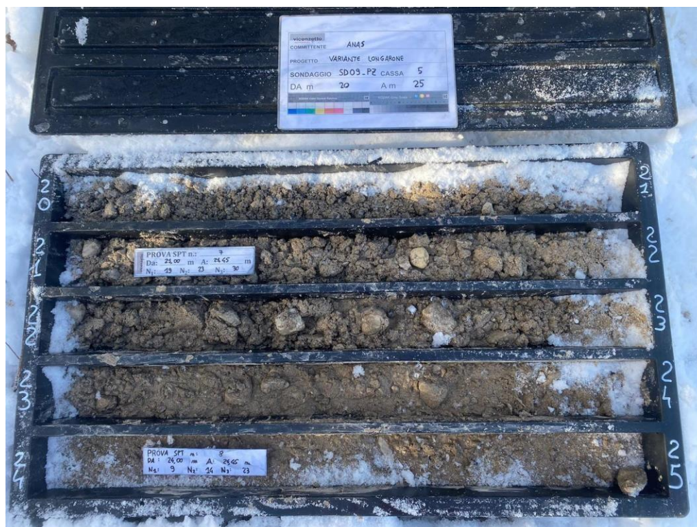
Fig. 109 – Sondaggio SD09_PZ, cassetta del carotaggio da 20 a 25 m da pc. con ghiaie prevalenti
