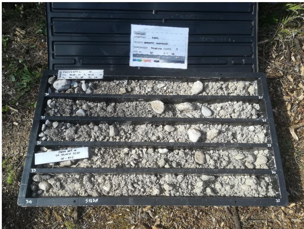
Fig. 117 – SD16_DH in corrispondenza della spalla sinistra del Viadotto Maè, cassetta del carotaggio da 30 a 35 m da pc.
