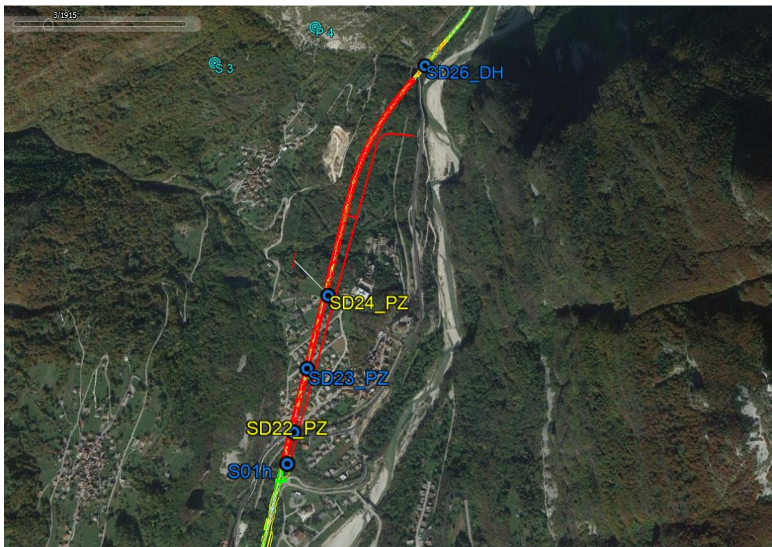
Tracciato della Galleria Castellavazzo
