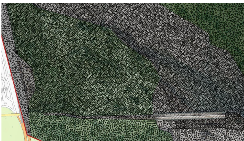
Figura 2.4-1 Esempio di mesh di calcolo a monte della traversa di Soverzene.
