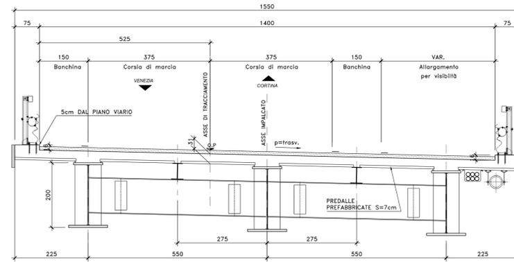
SEZIONE TRASVERSALE IN ASSE PILE 1-2 (VIO1 FRARI)
