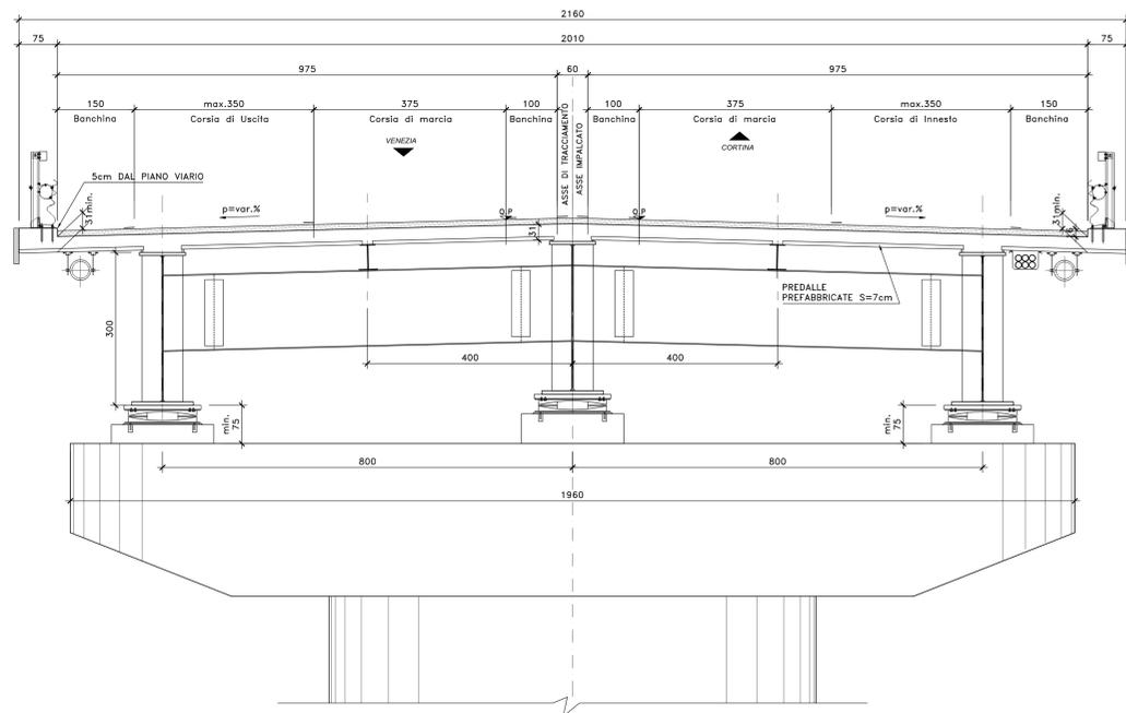
SEZIONE TRASVERSALE IN ASSE PILE DA 3 A 7 (VIO1 FRARI)
