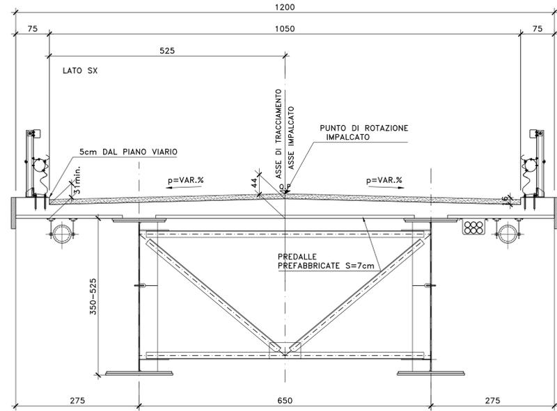
SEZIONE TRASVERSALE CARPENTERIA IMPALCATO IN ALLARGAMENTO (VIO4 MAE)
