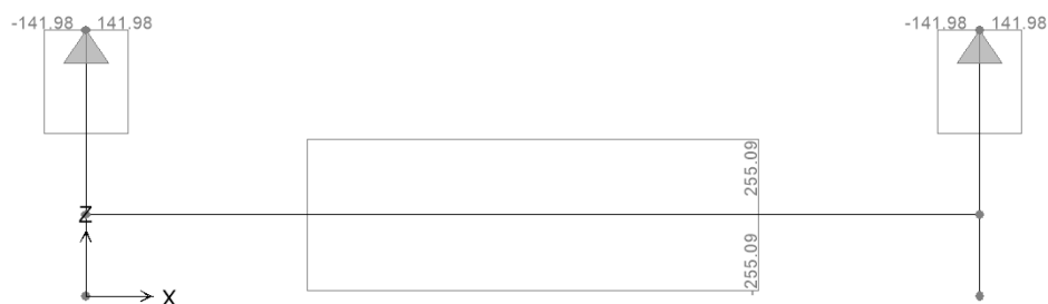
Figura 6.14. Trasverso di campata – Sforzo normale SLU
