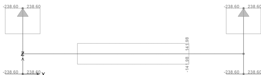
Figura 6.15. Trasverso di campata – Sforzo di taglio SLU
