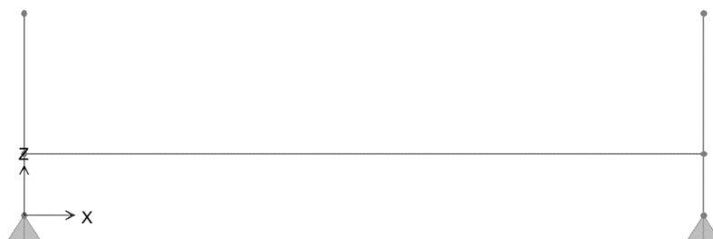
Figura 6.16. Modello di calcolo - Trasverso di appoggio - pila
