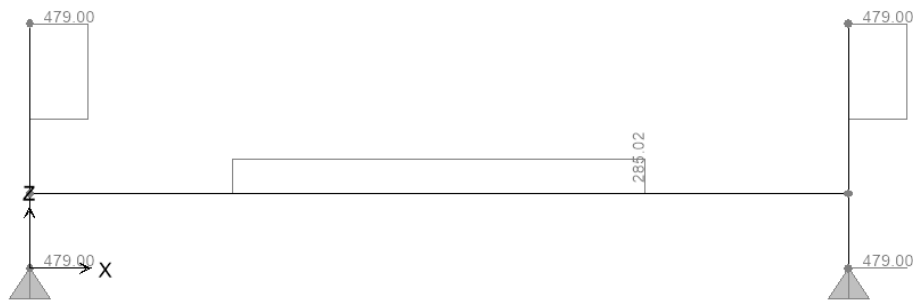
Figura 6.18. Trasverso di appoggio pila – Sforzo di taglio Ht-SLV
