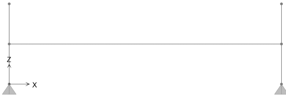
Figura 6.21. Modello di calcolo - Trasverso di appoggio – spalla
