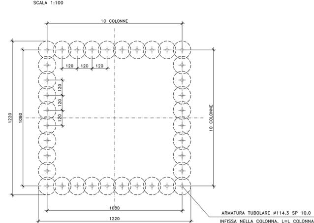
**DETTAGLIO DISPOSIZIONE JET-GROUTING #1400 SU PILE P1-P2-P3-P4 - N° 30 COLONNE**
