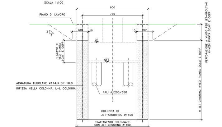
**DETTAGLIO DISPOSIZIONE JET-GROUTING #1400 SU SPALLA A - N° 36 COLONNE**
