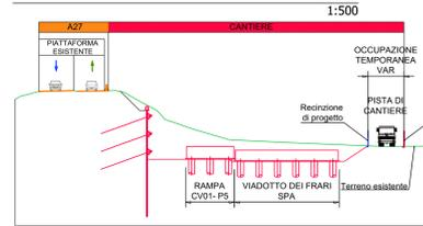
SUBCANTIERE A e B - Fase 1 (Sezione sviluppata)
