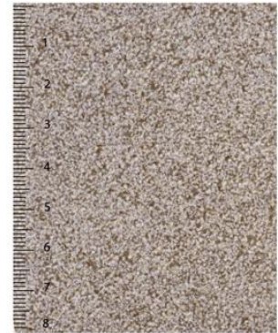
INGRANDIMENTO DELLA BOCCIARDATURA TIPOLOGIA: Punto, Layout random, Densità 160 pti/cm 2
