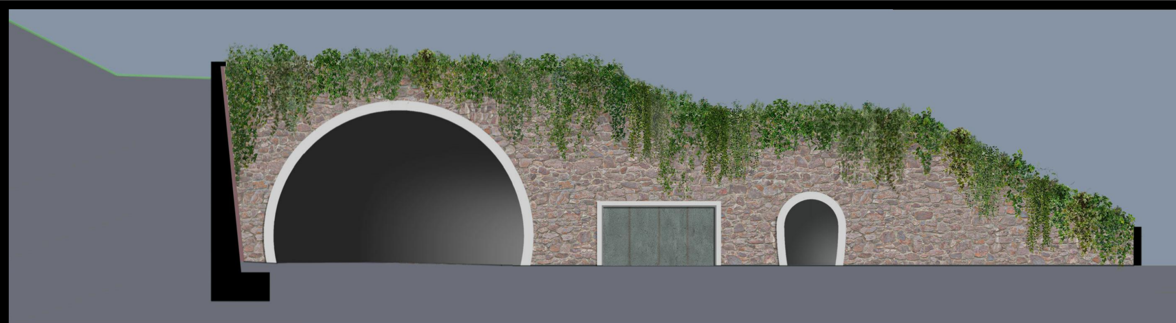
Portale dell'imbocco in galleria con rivestimento in pietra
