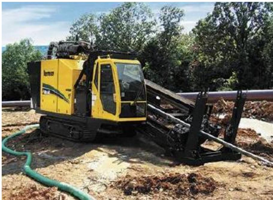
Figura 39. Esempio macchina perforatrice per TOC
