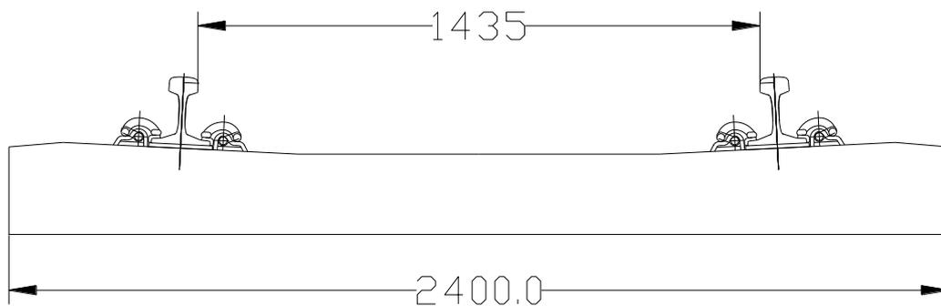
Il binario sarà armato con traverse tipo RFI 240 di lunghezza 2,40 m dotata di attacco di tipo elastico conforme alle Specifiche Tecniche RFI con scartamento di 1435 mm.
