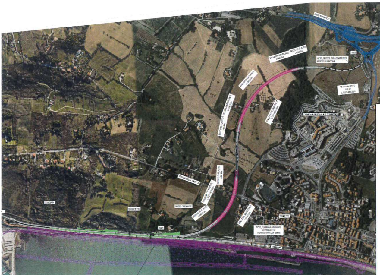
Fig. 2 – Tracciato di progetto (in rosa) con indicate le principali opere (viadotti e gallerie). In viola scuro e in blu sono indicati interventi afferenti ad altri progetti, esclusi dalla procedura in argomento.
