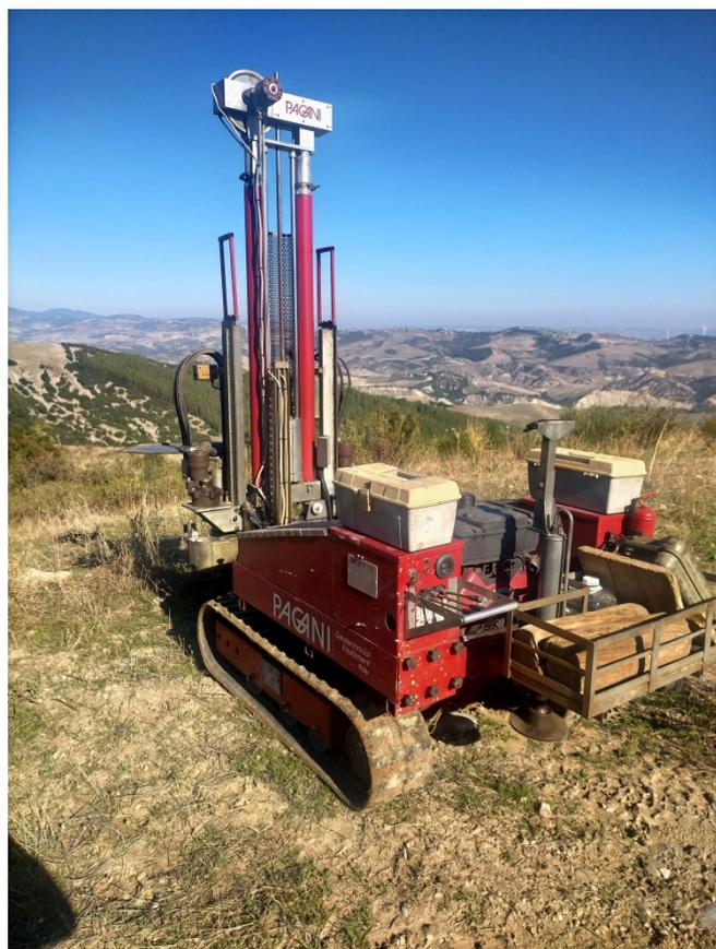
**Prova Penetrometrica TS\_DPSH1**
