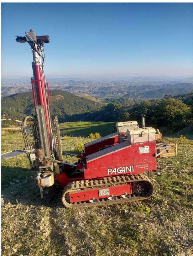
**Prova Penetrometrica TS\_DPSH2**
