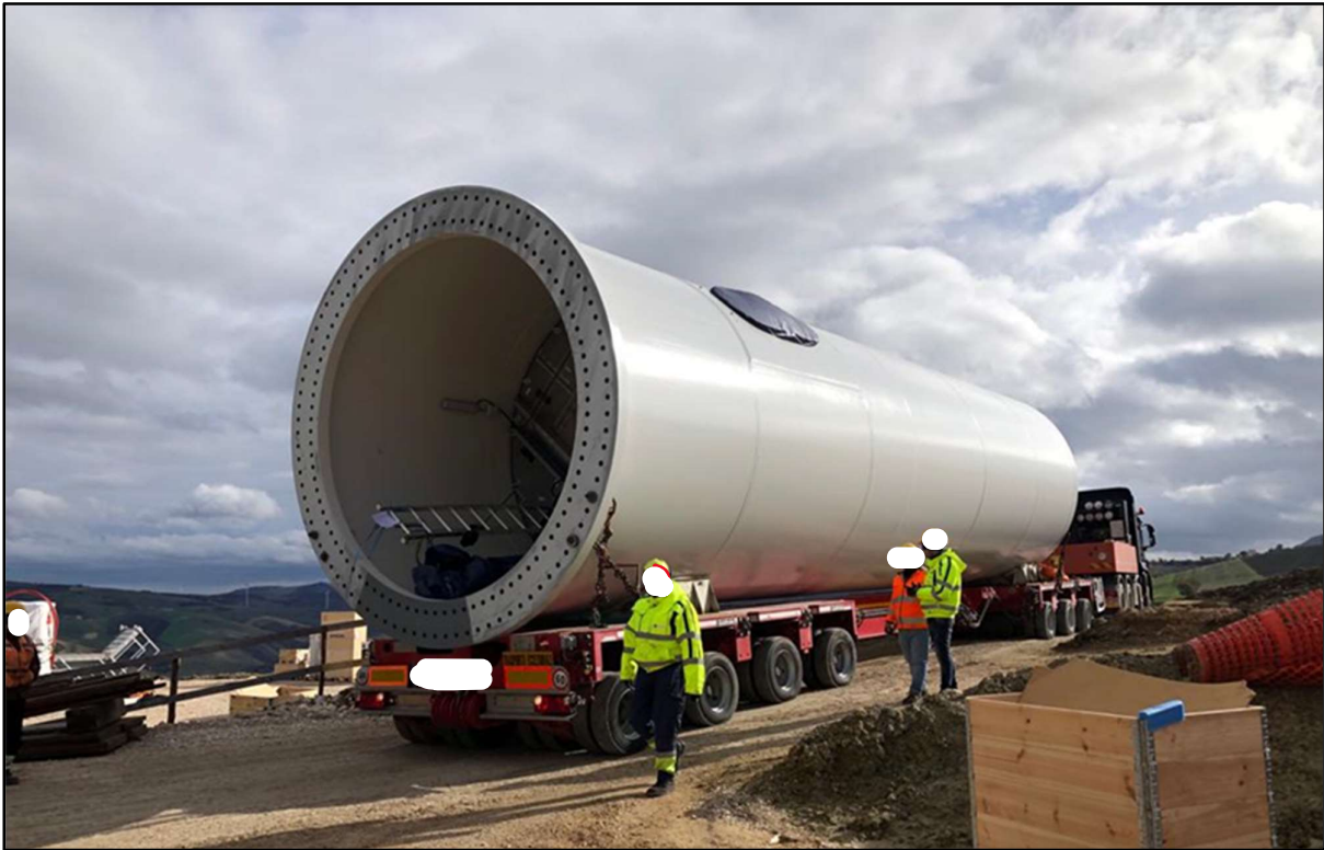
Figura 3.2: Mezzo speciale trasporto componenti WTG
