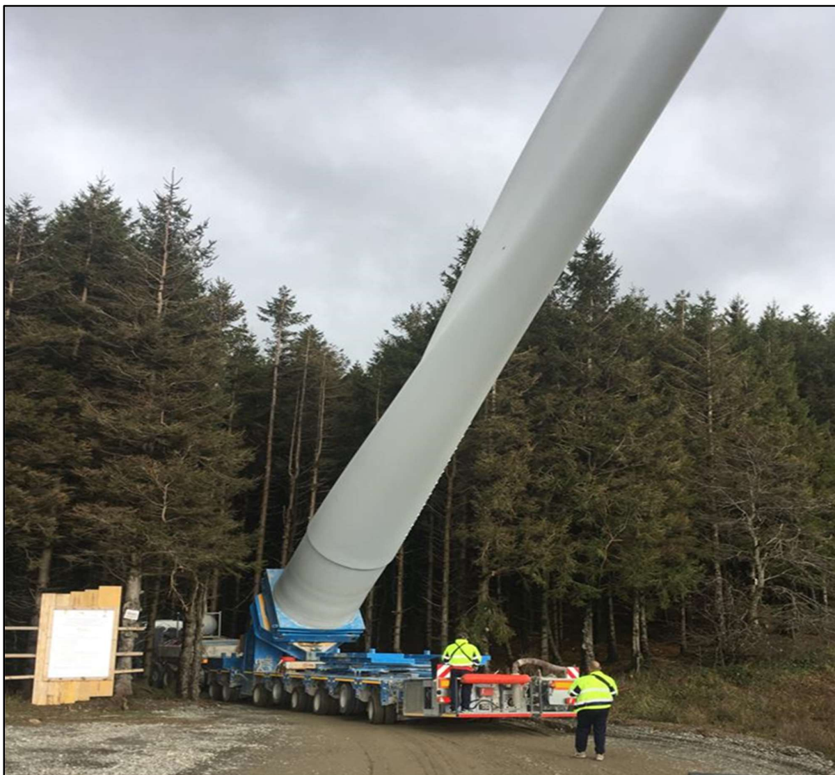
Figura 4.3: Trasporto con “Blade Lifter”
