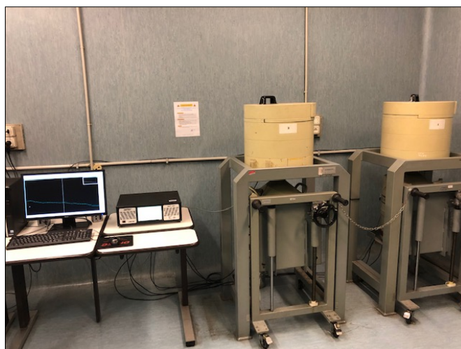
Figura 5 – Rivelatori al germanio iperpuro e relative catene di acquisizione dei segnali.
