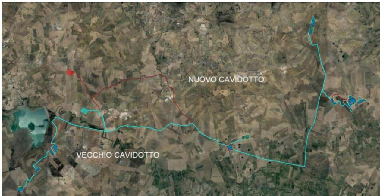
FIGURA 1 – MODIFICHE AL TRACCIATO DEL CAVIDOTTO TRA LE DUE FASI DELLA PROCEDURA: PRIMA ISTANZA (VECCHIO CAVIDOTTO) E INTEGRAZIONI (NUOVO CAVIDOTTO)
