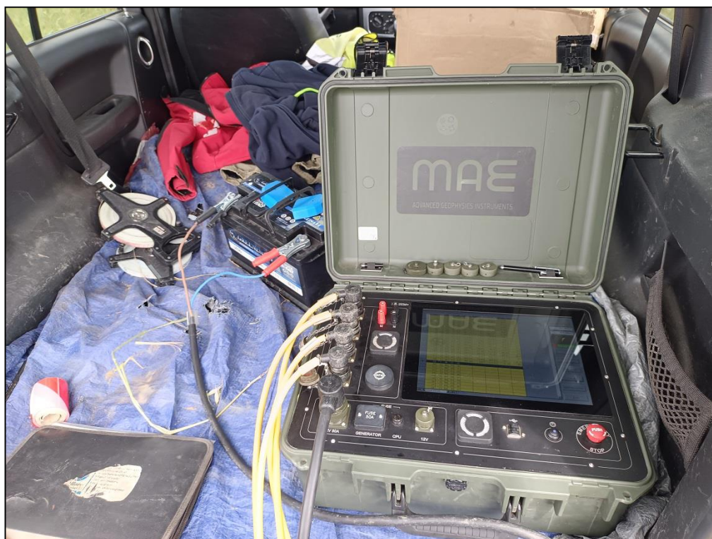
Figura 14. Georesistivimetro M.A.E. X612-EM+ (postazione ERT8 - "Area 8").
