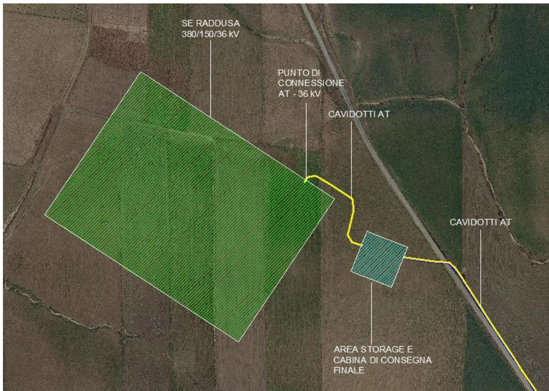
FIGURA 3: INQUADRAMENTO BATTERY PACK E SE RADDUSA 380/150/36 kV
