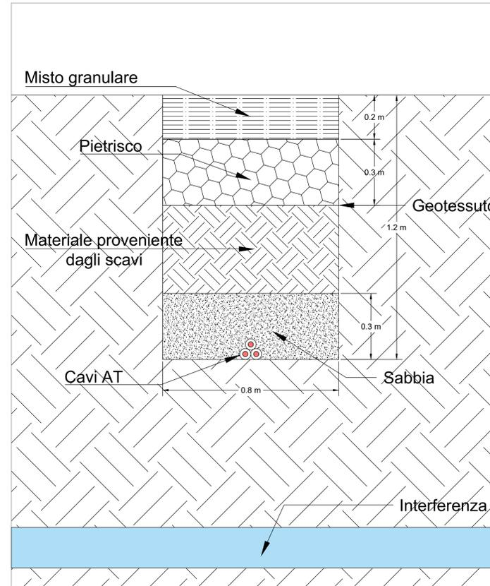
**Sezione C-C: cavidotto esterno**
