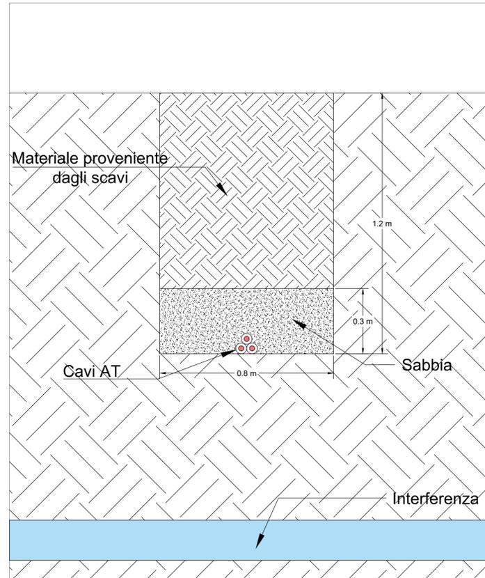
**Sezione B-B: cavidotto interno**
