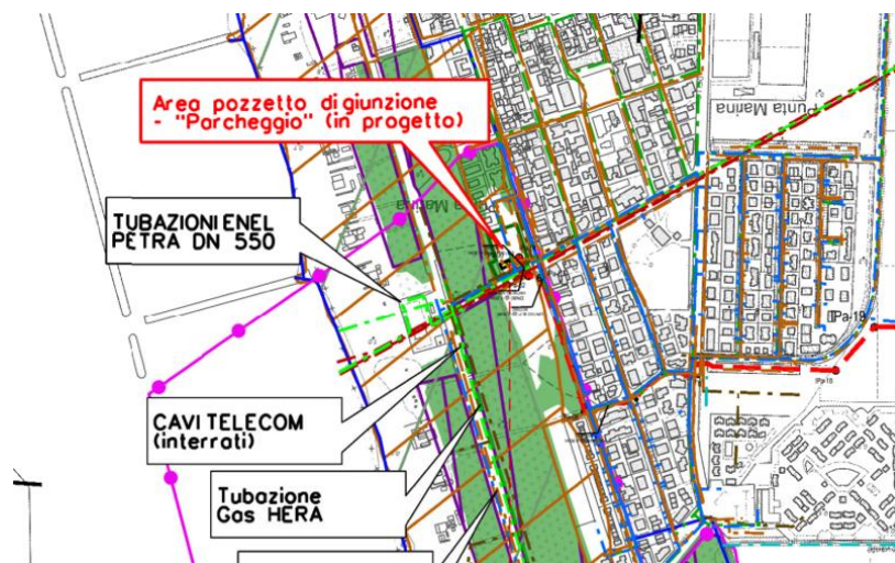
Figura 5: Percorso elettrodotti in T.O.C. sotterraneo limitrofo all'area boschiva del Riserva Naturale dello Stato "Pineta di Ravenna" (doc. AGNROM_EP-F_INQ-TRACCIATO-VINNAZ)
