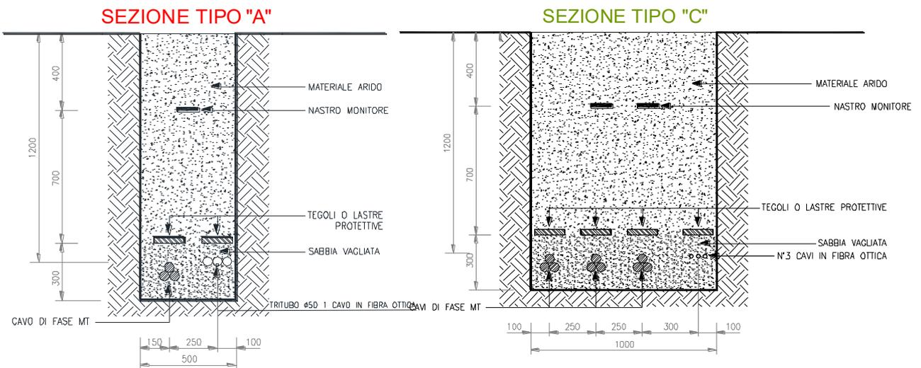
**Figura 2:** Sezione tipica di posa della linea in cavo su strade sterrate
