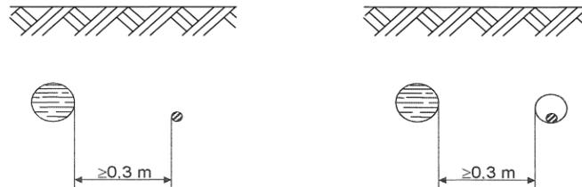
Incroci e parallelismi tra cavi di energia in tubazione e tubazioni di gas con densità non superiore a 0,8 non drenate con pressione massima di esercizio >5 Bar
