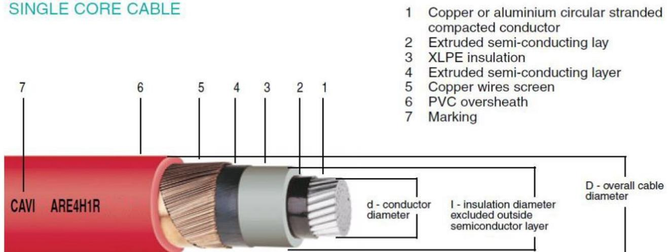
**Figura 1: caratteristiche cavi unipolari**
