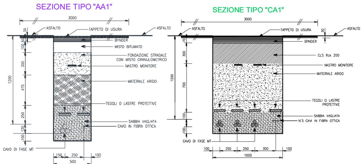
**Figura 3:** Sezione tipica di posa della linea in cavo su sede stradale
