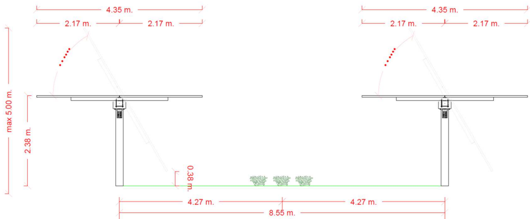
Schema coltivazione agro-fotovoltaico
