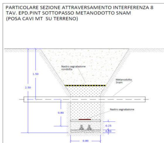
Fig. 22 - Particolare superamento Interferenza
