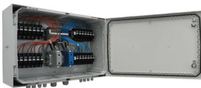
Le string box vengono posizionate sotto le strutture dei tracker e, a seconda delle esigenze, possono consentire il parallelo di 16 o 17 stringhe. Hanno grado di protezione IP65 e garantiscono con il loro involucro lunga durata e sicurezza nei collegamenti.
