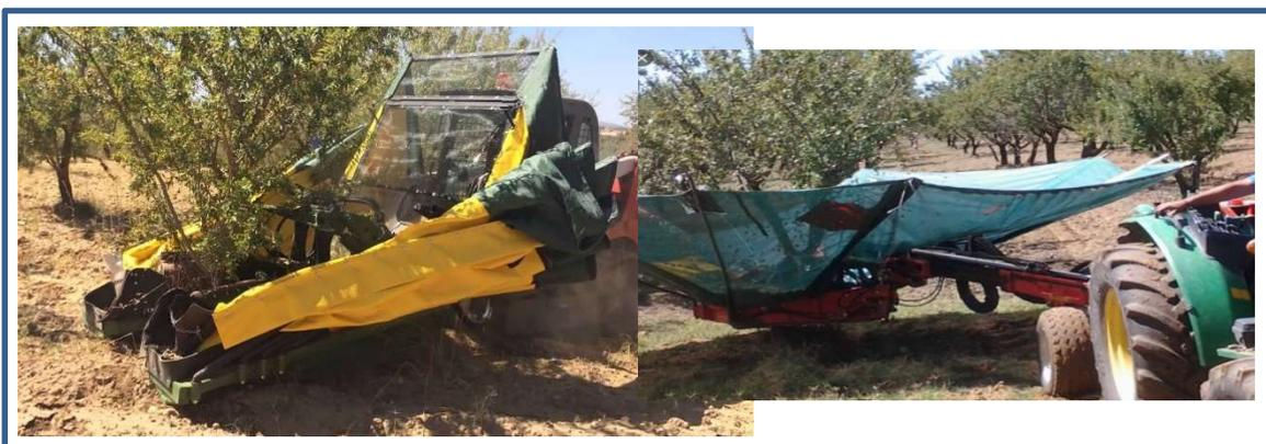
77 – esempi di macchine operatrici per la raccolta delle mandorle ad uso intensivo
