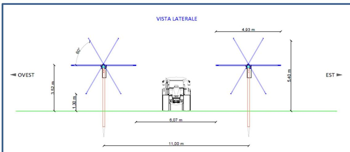
62 – Particolari costruttivi con evidenza della rotazione del tracker e del pitch
