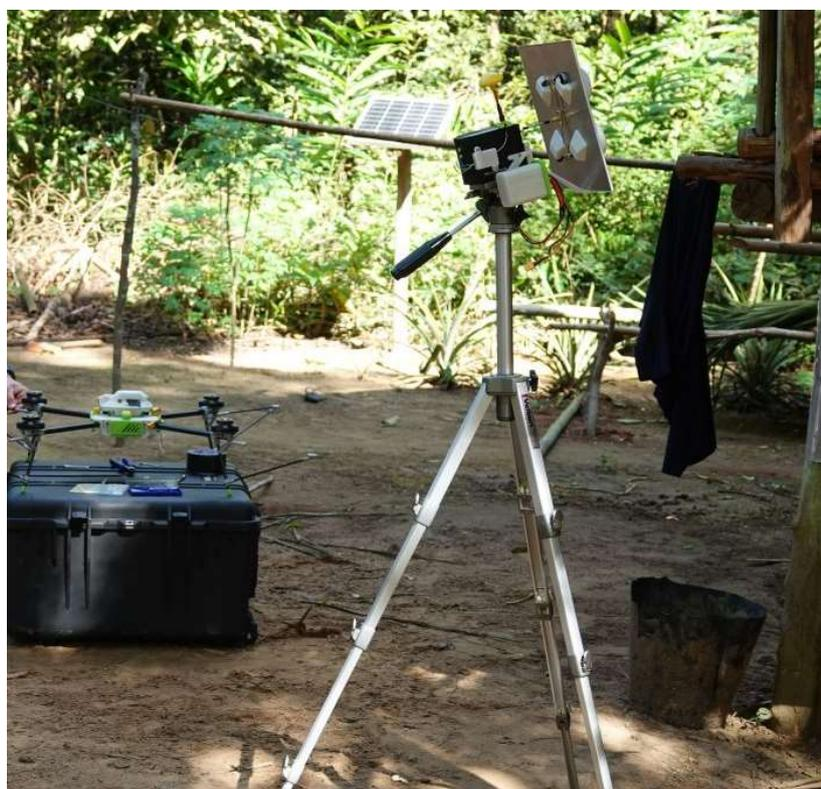
Il monitoraggio di parametri climatici, fenologici e produttivi può essere effettuato con droni o con kit prossimali basati su tecnologie in cui il sensore remoto (remote sensing) è a diretto contatto con l'oggetto da monitorare: terreno, foglie, frutto, ecc.
