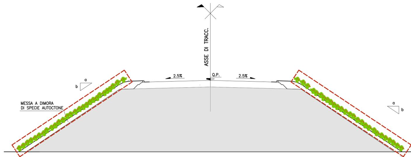
SISTEMAZIONE A VERDE SEZIONE TIPO IN SCAVO
