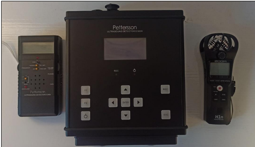
Figura 25 – Attrezzatura utilizzata per il monitoraggio chiroteri. Da sinistra: rilevatore a eterodina ed espansione temporale (x10 e x20 selezionabile), Bat detector D 500X per la registrazione prolungata nel campo degli ultrasuoni, e registratore multitraccia collegato al D 240 X
