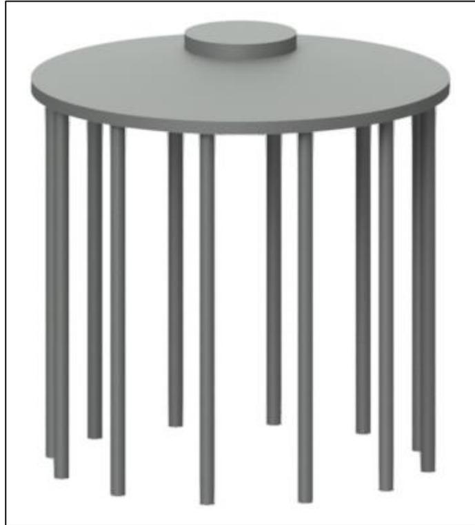
Figura 4: vista tridimensionale della fondazione dell'aerogeneratore
