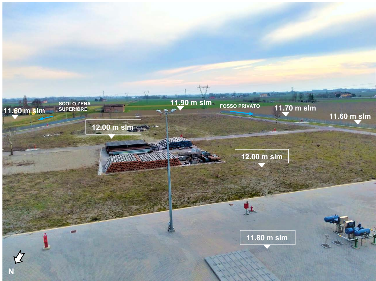
Figura 9.13 – Fotografia panoramica dell’area in esame con riferimenti altimetrici del piano campagna e del piano di imposta di progetto (quote nei riquadri)
