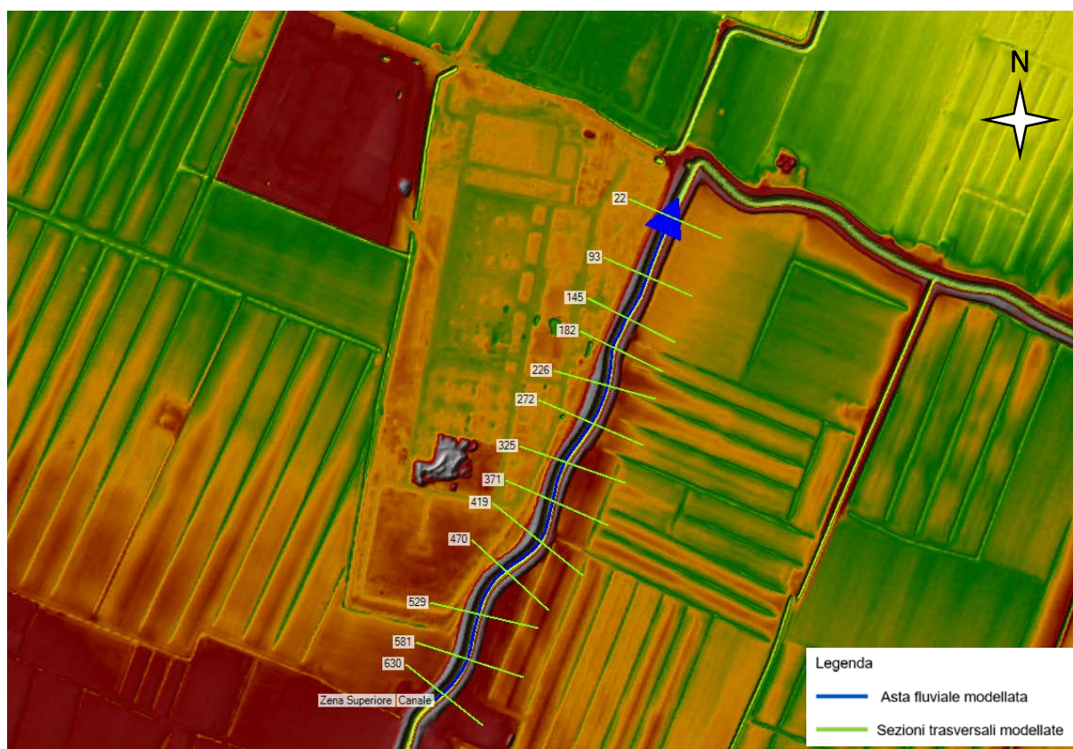
Figura 7.2 – DTM, con tronco d'alveo analizzato e sezioni di input nella modellazione
