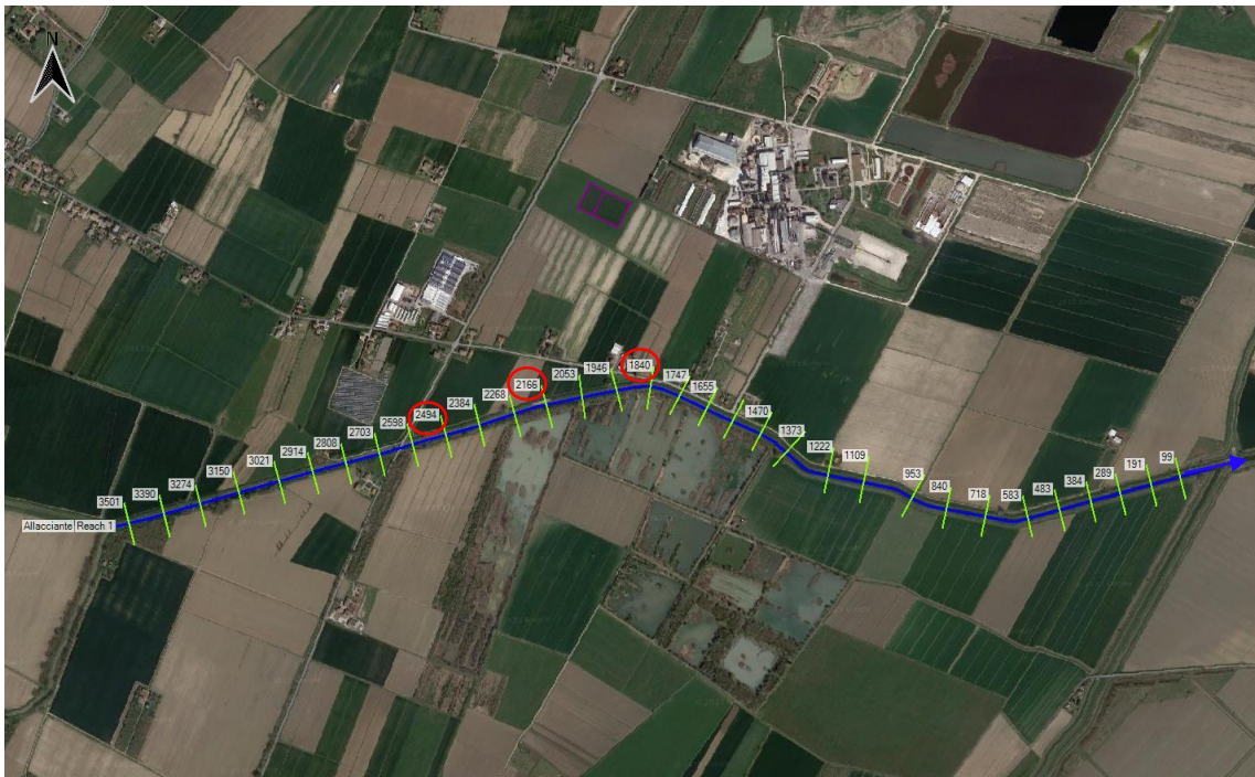
Figura 18 - Inquadramento su base satellitare del tronco d'alveo analizzato e sezioni di input nella modellazione (evidenziate in rosso tre sezioni significative in prossimità della SE-SSE)
