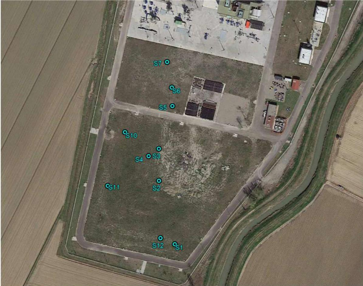
*Figura 3 – Ubicazione dei sondaggi eseguiti in area interna "Unità ELCO EC8"*
